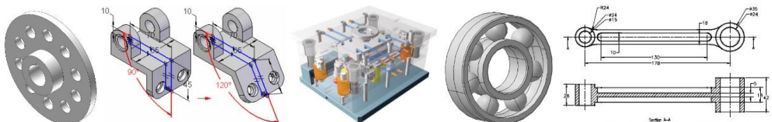
Слика 4: Карактеристике CAD софтвера – моделирање фичерима, параметарско моделирање, моделирање склопова, стандардни елементи, техничка документација
