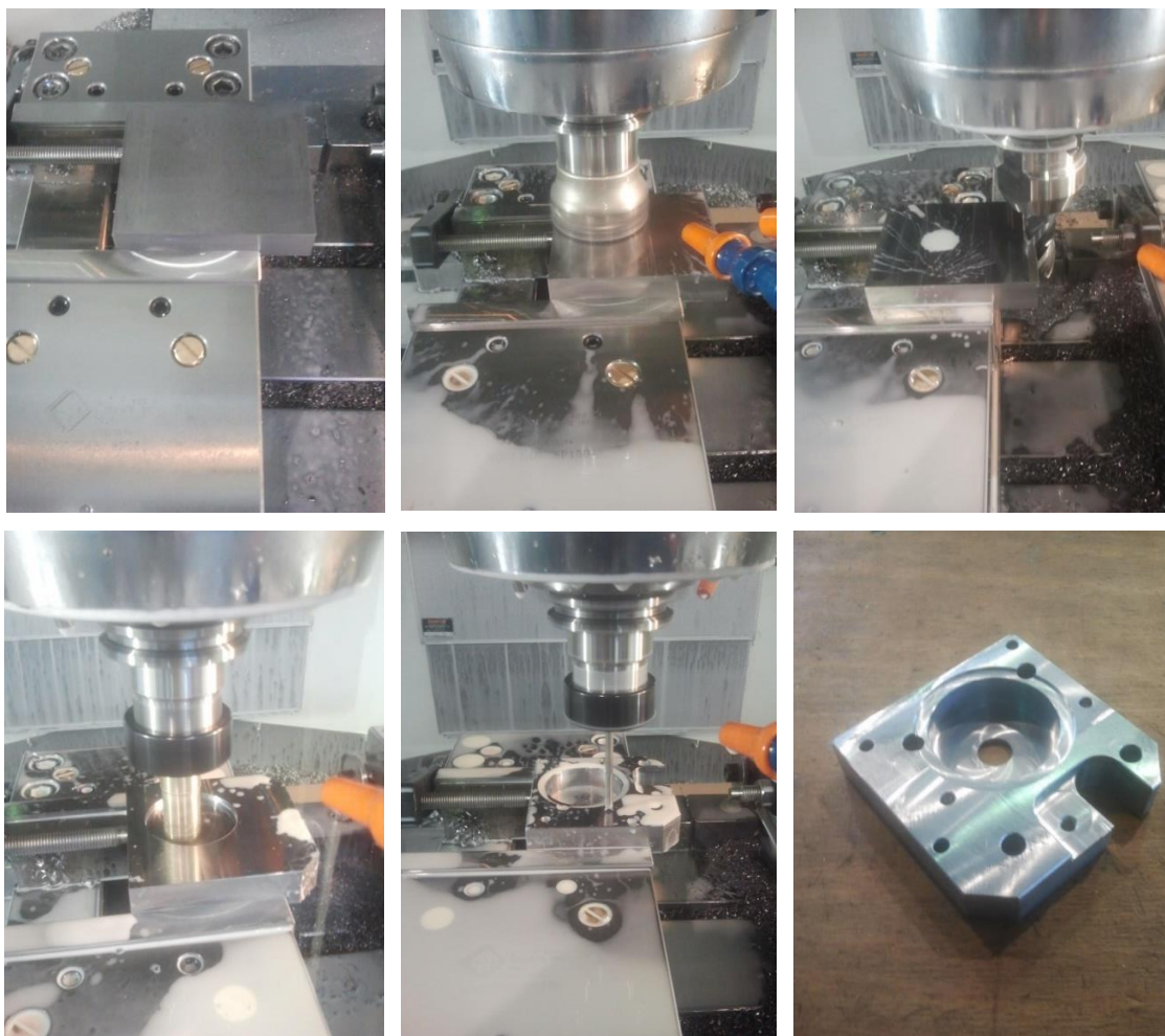
Слика 39: Процес израде од монтаже до готовог дела и карактеристични захвати
