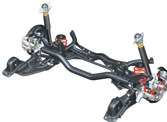
Слика 5.1. Систем задње осовине за погон на предњим точковима [10]
