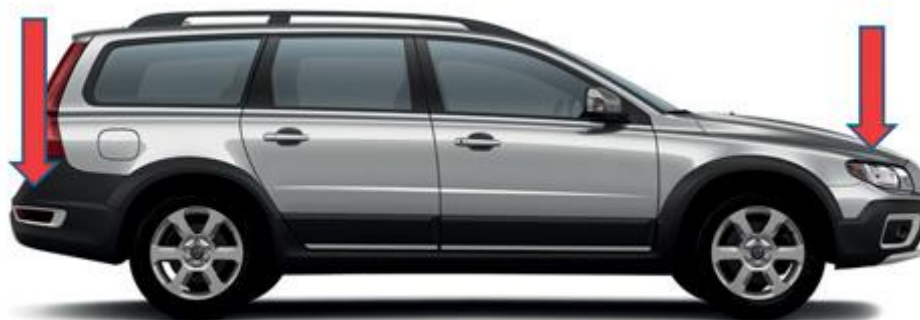
Слика 4.3 Тест амортизера (одскакање) [1]
