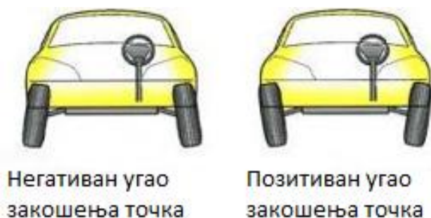
Слика 6.26 Позитиван и негативан угао закошења точка
