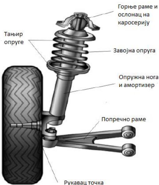
Слика 2.11 Макферсонова опружна нога са завојном опругом [9]
