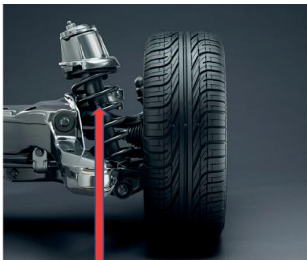
Слика 4.1 Провера цурења на амортизеру [1]
