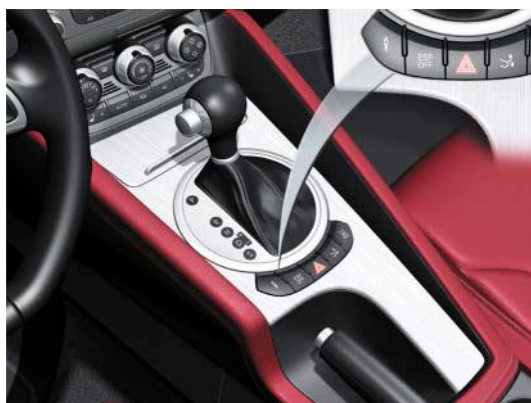
Слика 5.9 Изглед и положај дугмета за подешавање пригушења амортизера [10]
