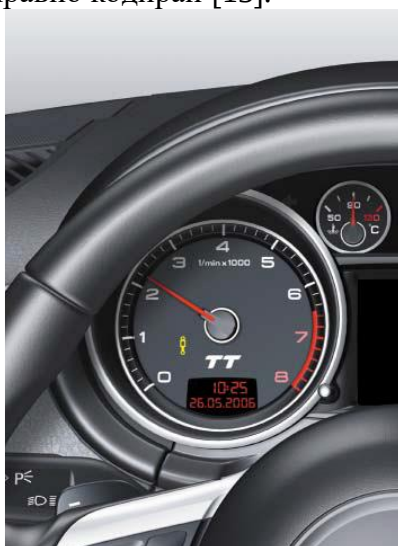
Слика 5.10 Изглед лампице упозорења на панелу на табли [10]
