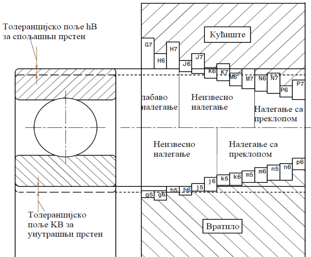
Слика 5 – Толеранцијска поља лежаја и елемената који су у контакту са лежајем, [1]
