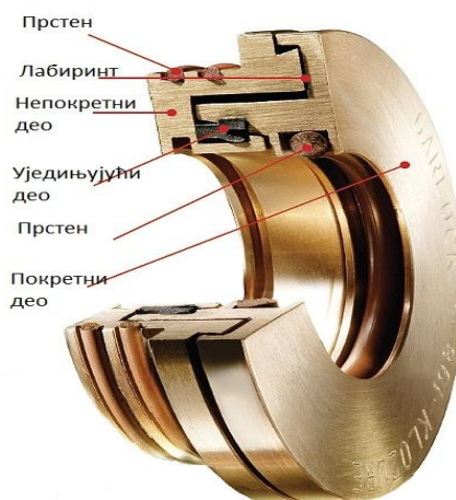
Слика 50 – Лабиринтски заптивач
