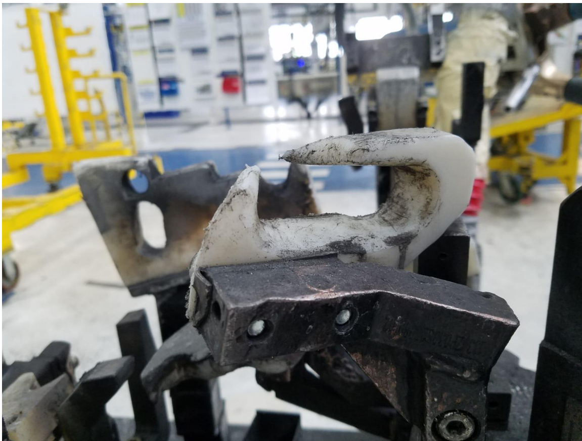
Слика 2. Изглед оштећене вођице
