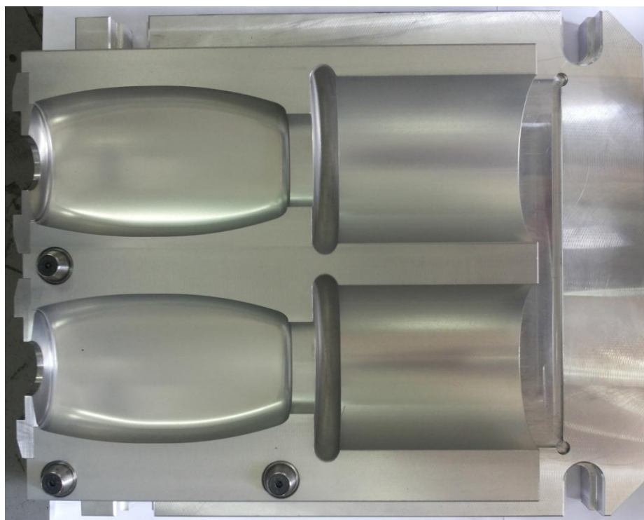
Слика 80. Алат наком машинске, термичке и хемиске обраде
