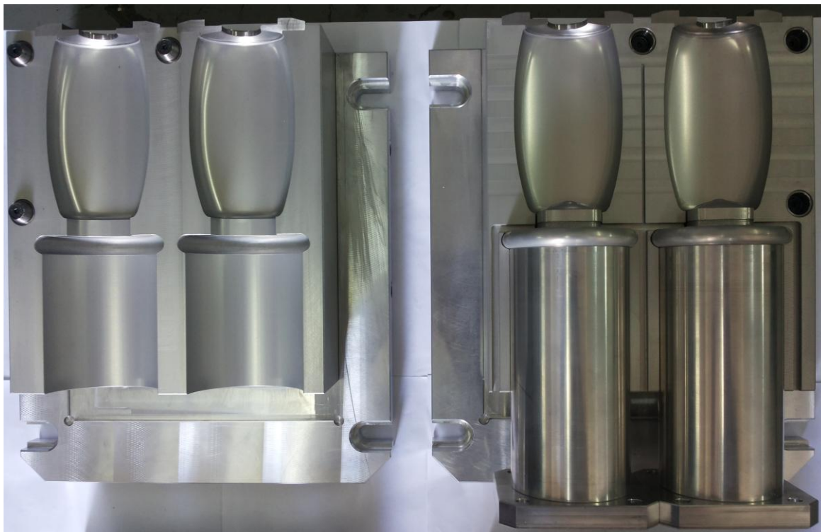
Слика 78. Алат након машинске, термичке и хемијске обраде
