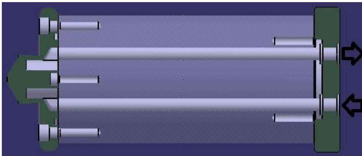
Слика 12. Систем за хлађење и расхлађивање dna алата
