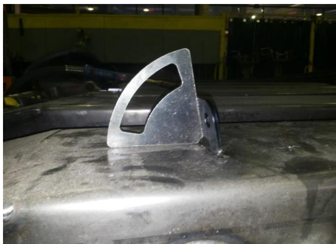
Слика 10. Soft Poka yoke за контролу угла на крају производње
