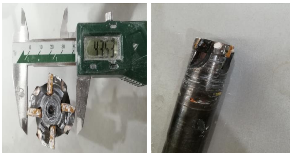
Слика 71. Приказ глодала са изменљивим плочицама
