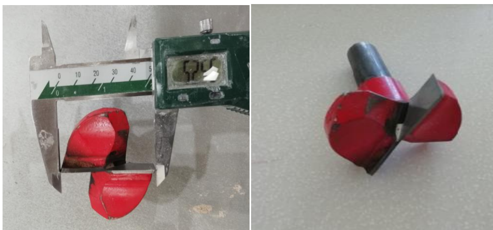
Слика 70. Приказ глодала са заземљеним плочицама
