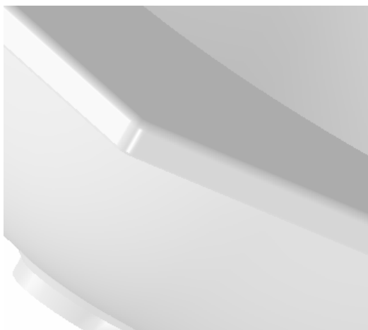
Слика 27. Коришћење опције Fillet
