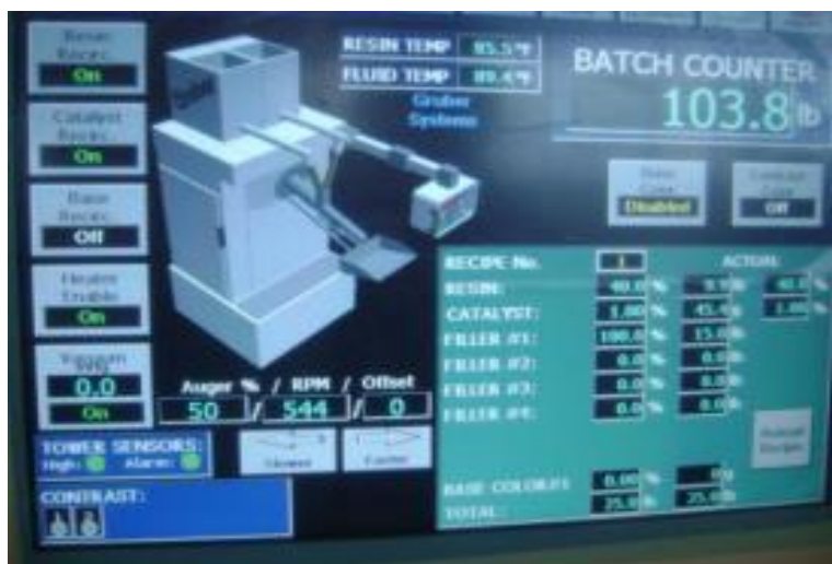
Слика 35. Управљачка јединица Auto caster машине
