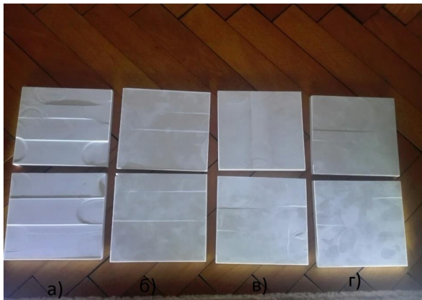
Слика 76. Приказ плочица од материјала Granmatrix 1 након обраде и сечења; а) глодало са дијамантским прахом, б) двоперо глодало, в) глодало са изменљивим плочицама, г) четвороперо глодало
