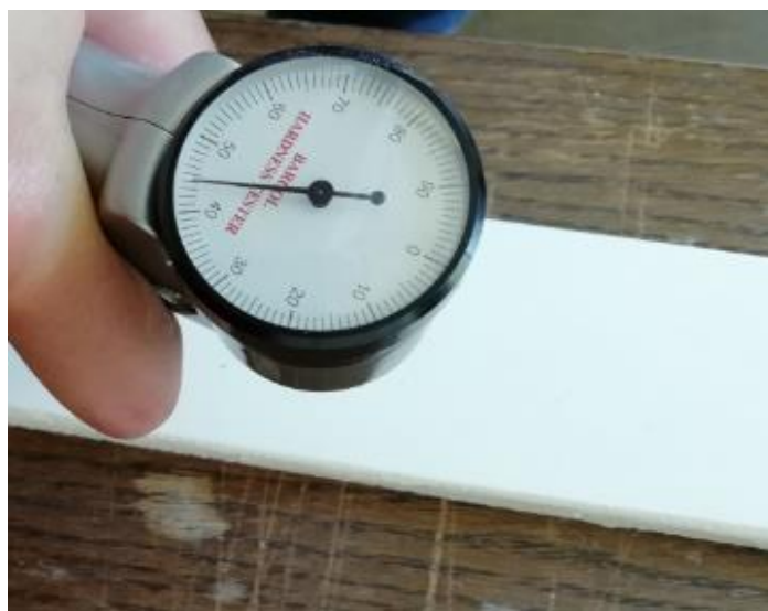
Слика 64. Тврдоћа плочица од Granmatrix 1 материјала
