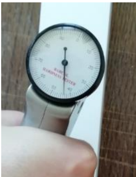
Слика 65. Тврдоћа плочица од Granmatrix 2 материјала
