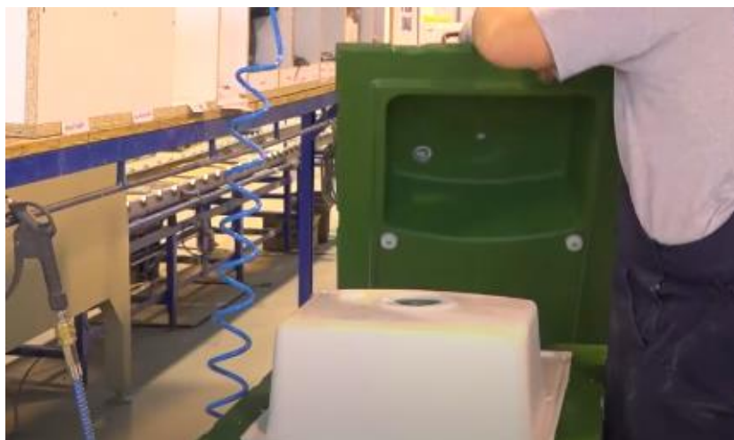
Слика 37. Вађење дела из калупа
