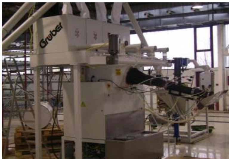
Слика 34. Приказ машине Auto caster за ливење
