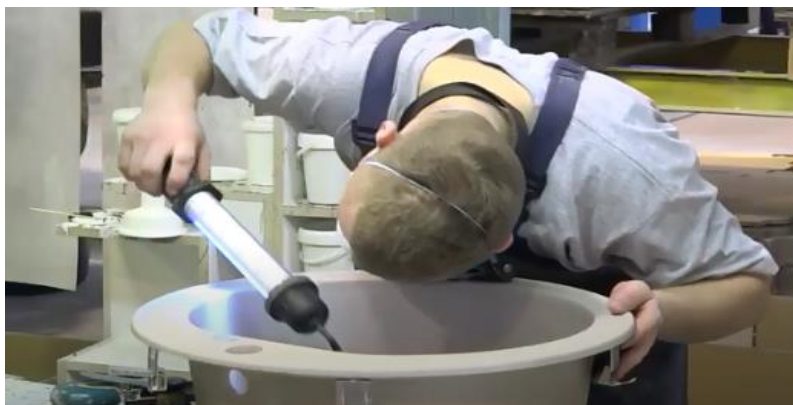
Слика 57. Контрола површине умиваоника помоћу лампе
