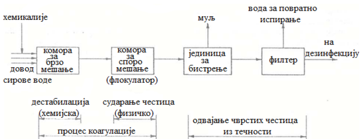
Слика 2.13 Блок шема процеса коагулације
