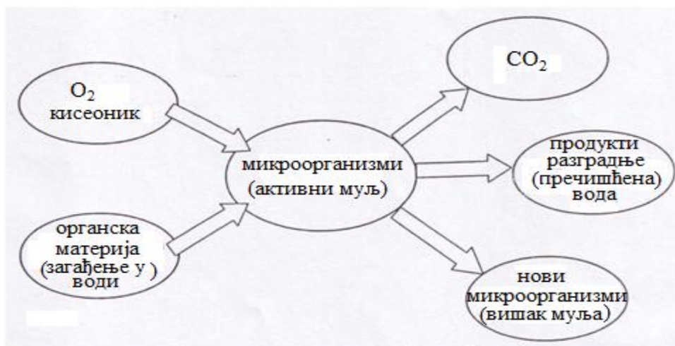
Слика 2.10 Принципи биолошког поступка са применом активног муља за обраду отпадних вода
