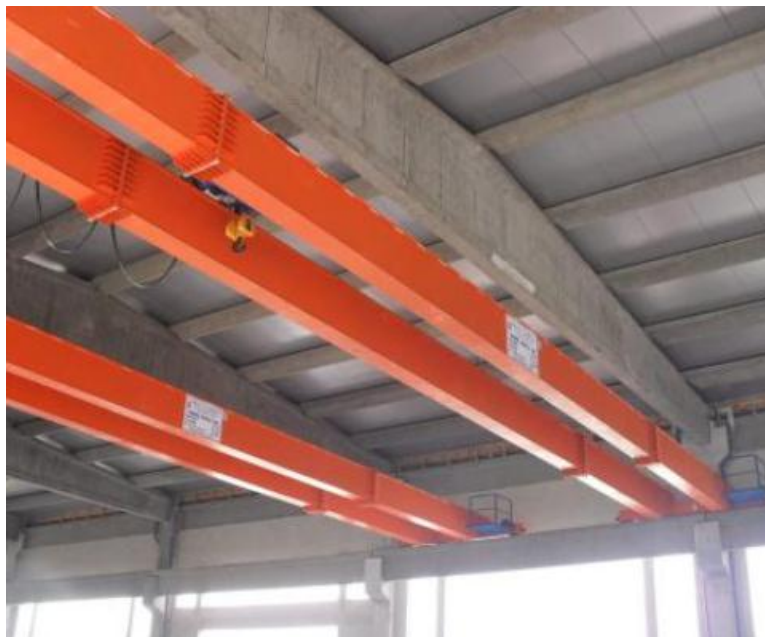
Слика 23. Двогредна мосна дизалица [12]
