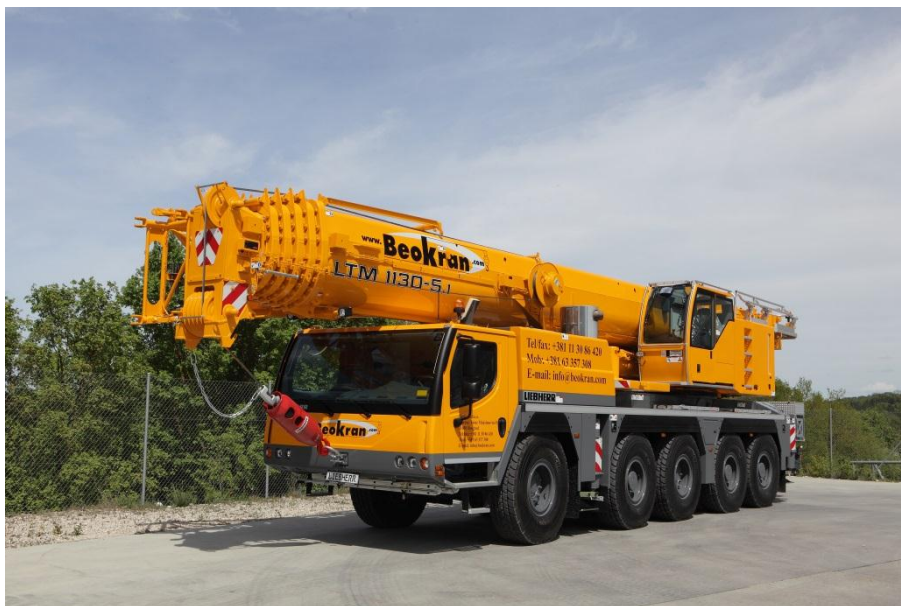
Слика 20. Изглед телескопске аутодизалице, [11]
