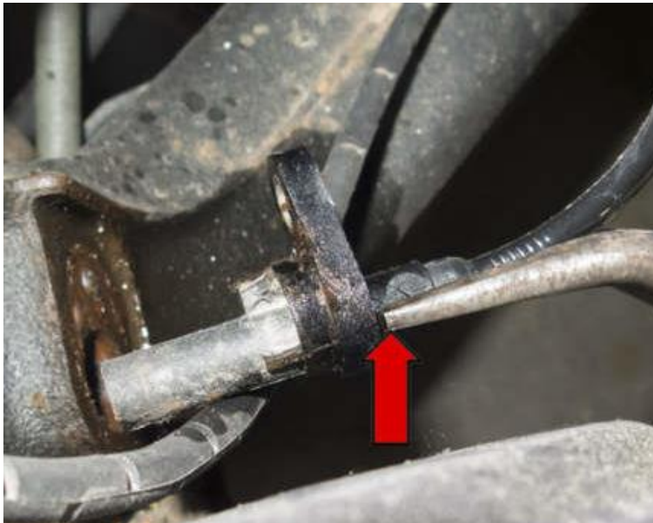
Слика 4.3 Пасивни давач броја обртаја примењен на возилу
