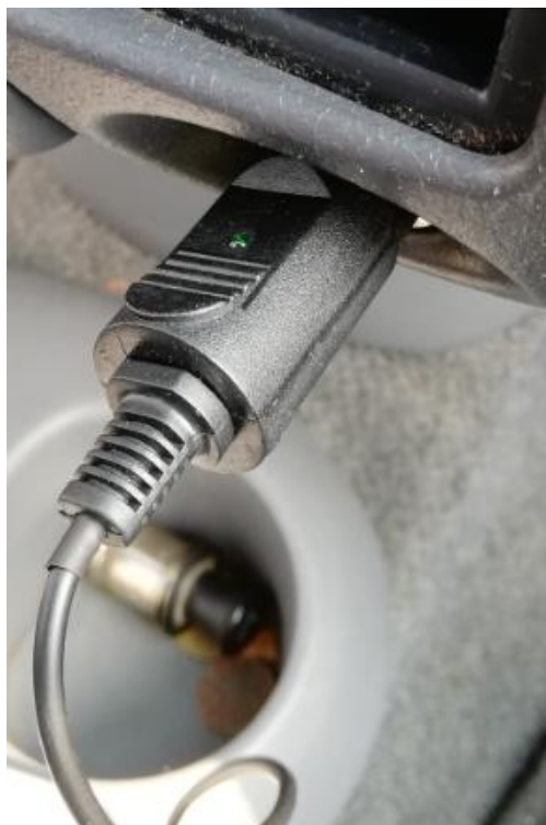
Слика 5.6 Повезивање путем утичнице упаљача у возилу
