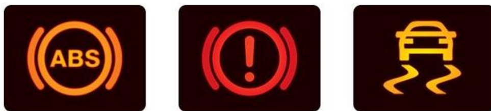
Слика 4.20 Сигналне лампице ABS-а [2]
