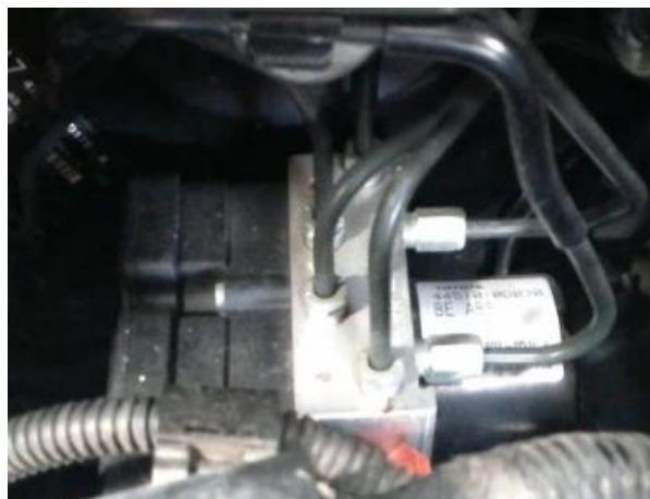
Слика 4.16 Хидраулички модулатор примењен на возилу Toyota Yaris
