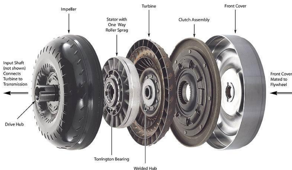
Слика 7. Лопатична кола турбомењача
