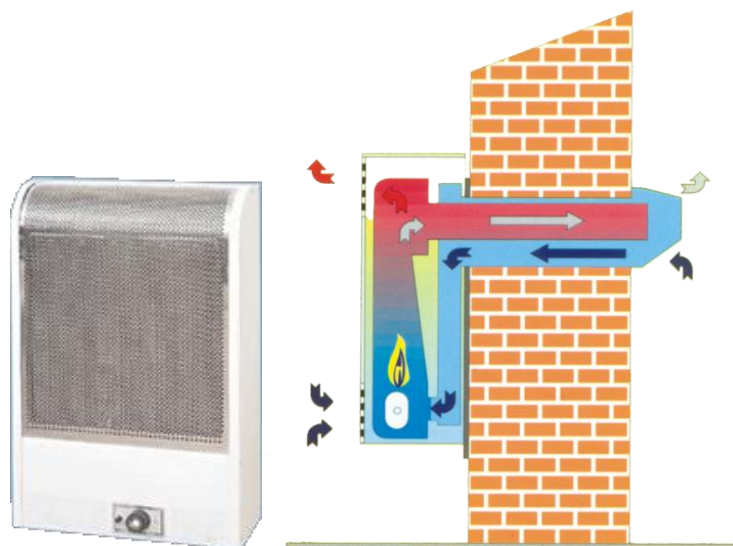
Слика 5.5 – Пример гасног уређаја ALFA-PLAM са прикључком на фасаду [10]
