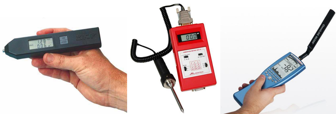
Слика 10. Инструменти за мерење вибрација: а) вибрациона оловка (лево), б) Vibration meter VM110 - ручни уређај за мерење вибрација (у средини), в) HF-6080 V4 - уређај за мерење вибрација (десно)
