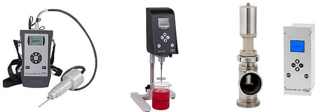
Слика 14. Аутоматски вискозиметри: а) дигитални вискозиметар (лево), б) ротирајући вискозиметар (у средини), в) on-line вискозиметар (десно)
