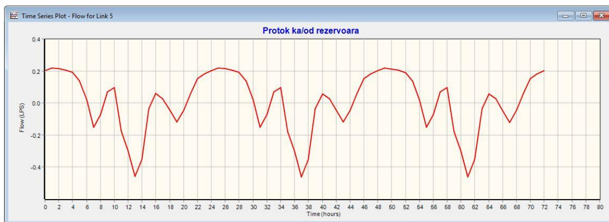
Слика 8.8. Проток ка/од сабирног резервоара
