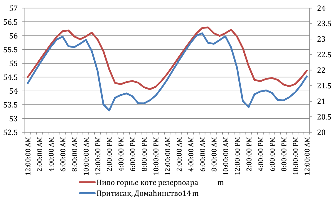
Слика 8.9. Зависност притиска од нивоа воде резервоара
