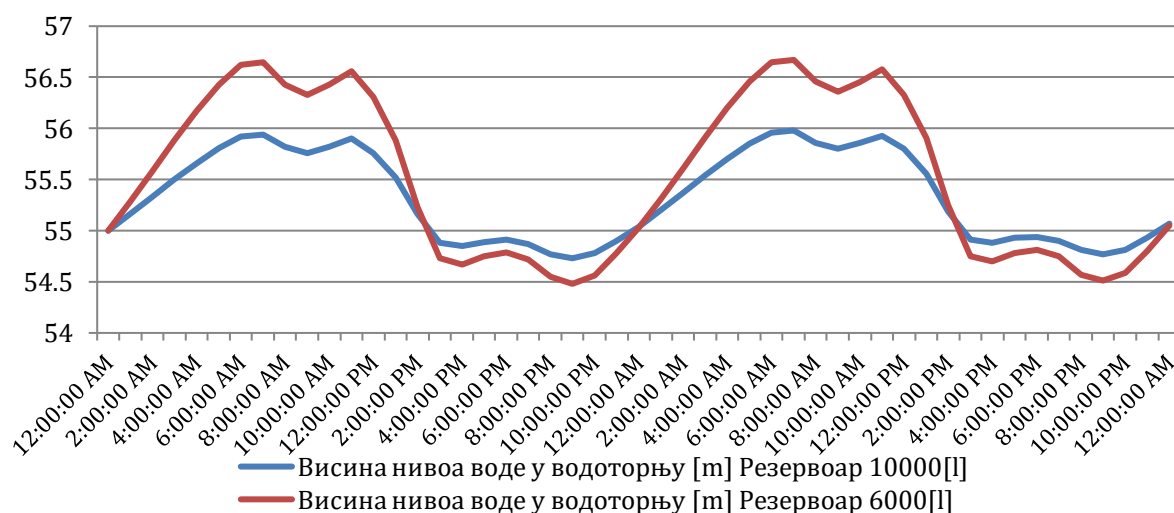
Слика 8.6. Осцилације нивоа воде у водоторњу
