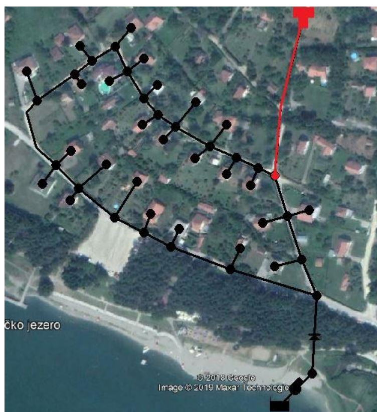
Слика 4.1. Прстенаста мрежа са резервоаром
