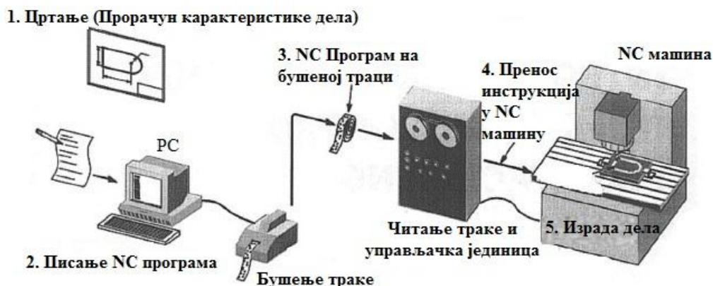
Слика 1.6: Компоненте класичних NC система
