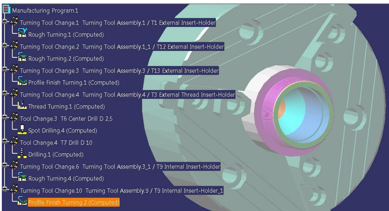
Слика 3.2.62: Списак захвата за прву технолошку операцију
