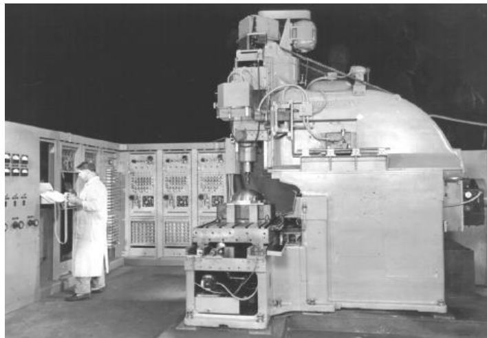
Слика 1.5: Прва NC машина алатка
