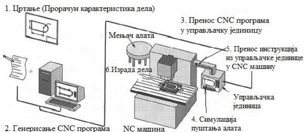
Слика 1.7: Компоненте савременог CNC система
