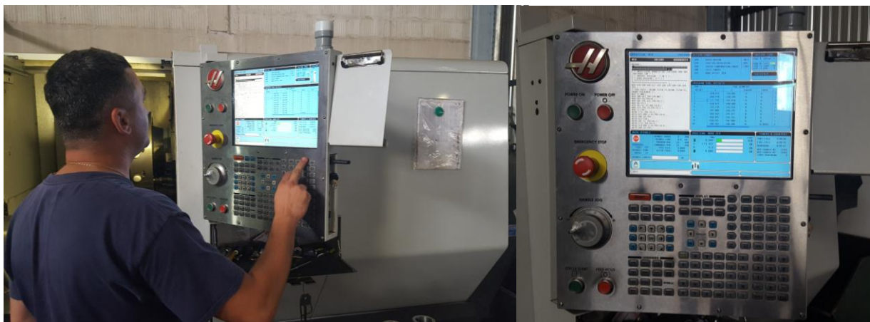
Слика 6.2: Корекција NC кода на управљачкој јединици
