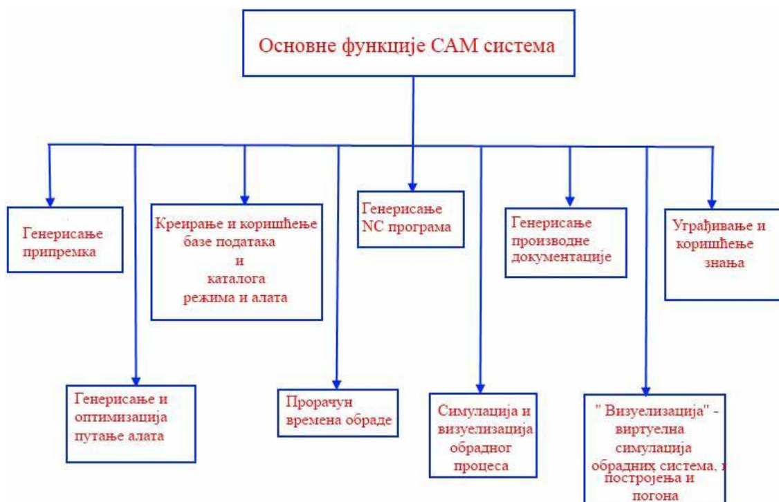
Слика 1.4: Основне функције пасивних САМ система
