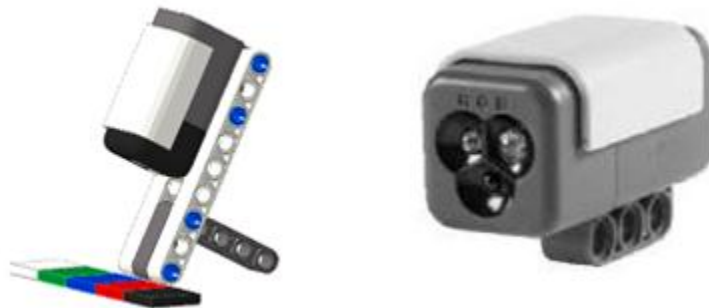
Слика 4.2.5. Позиционирање сензора за боју (лево) и сензор за боју (десно)
