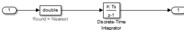
Слика 7.1.2.5. Дискретни интегратор за израчунавање угла нагиба
