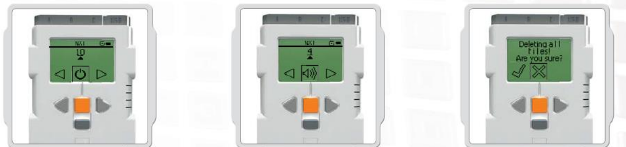
Слика 4.1.3. Мени који се односи на подешавања NXT програмабилне коцке – Settings мени
