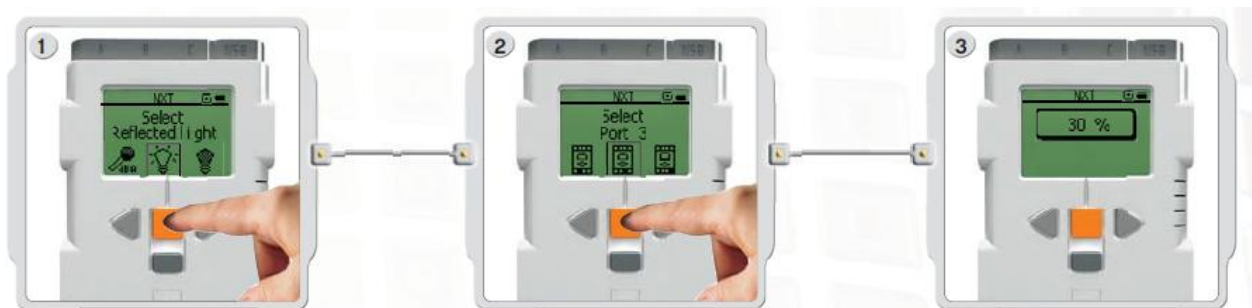
Слика 4.1.2. Тестирање сензора/мотора помоћу View менија
