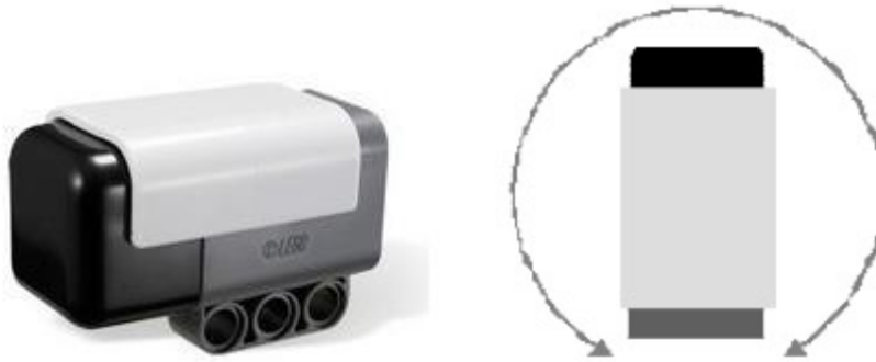
Слика 4.2.6. Жироскопски сензор (лево) и опсег сензора (десно)
