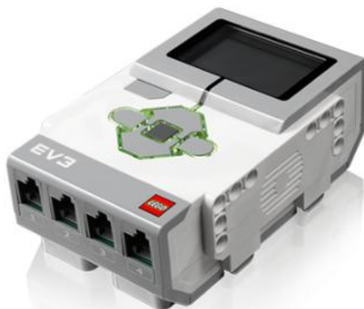
Слика 3.2.1. LEGO EV3 програмабилна коцка
