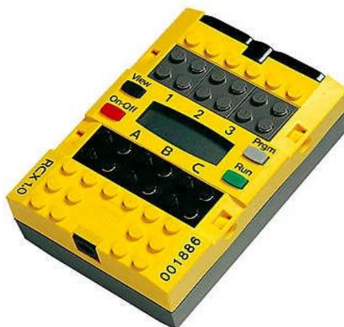
Слика 3.1.1. LEGO RCX програмабилна коцка
