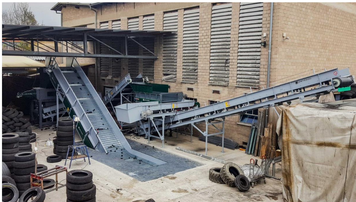
Слика 30. Постројење за дробљење, односно израду гранулата
