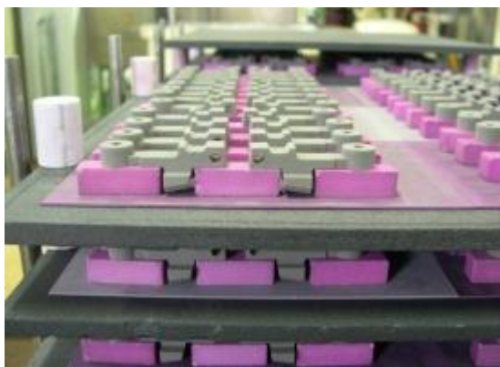
Слика 4.4.1 Позиционирање делова је током синтеровања.
