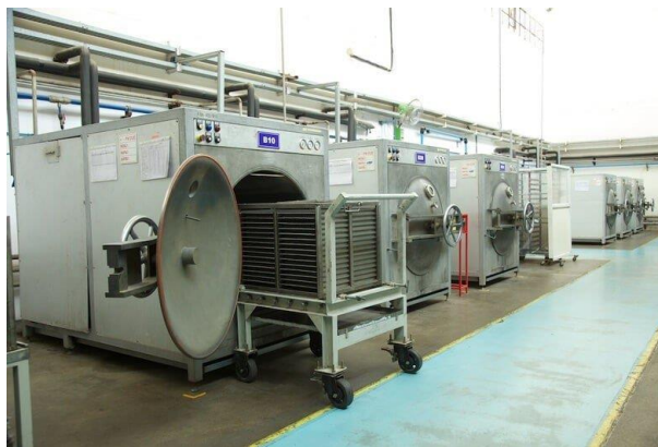
Слика 4.3. Процес уклањања везива [12]
