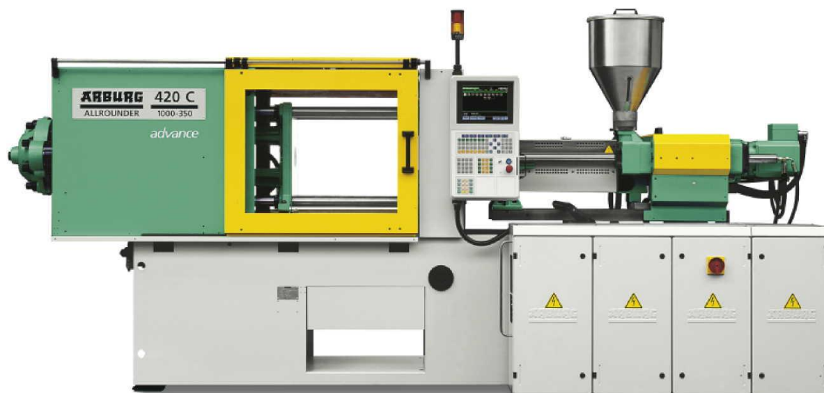
Слика 7.3. Машина за бризгање ARBURG Allrounder 420 C (1000-350) [17]
