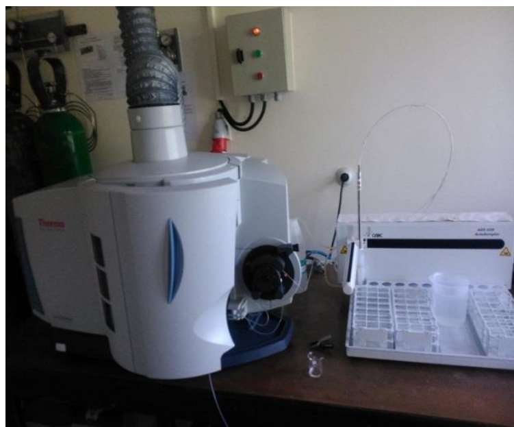
Слика 9.2. Спектрометар за одређивање хемијског састава
