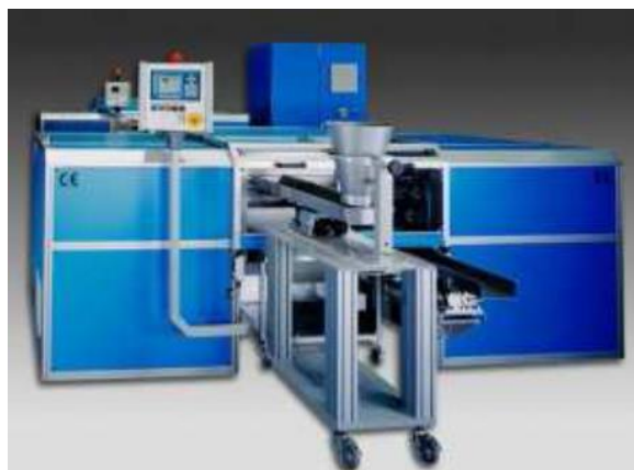
Слика 6.6. Ролне за сецкање за континуирану производњу сировина [13]
