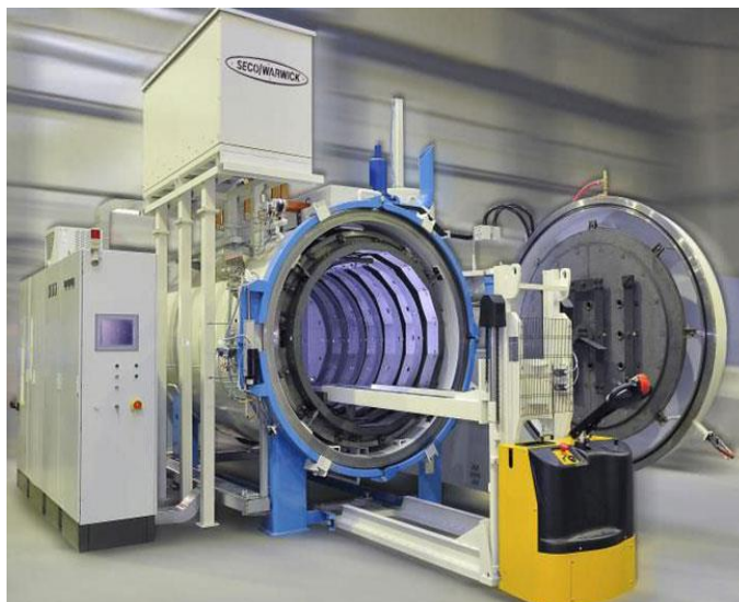
Слика 7.8. Стандардна вакуумска пећ за синтеровање [21]
