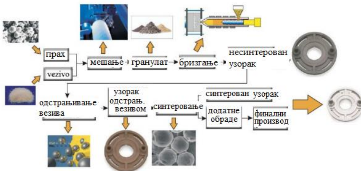
Слика 5. Редослед операција CIM технологије
