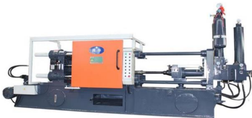
Слика 7.6.2. Машина за брызгање, модел „Bengbu Longhua 220t“ [18]
