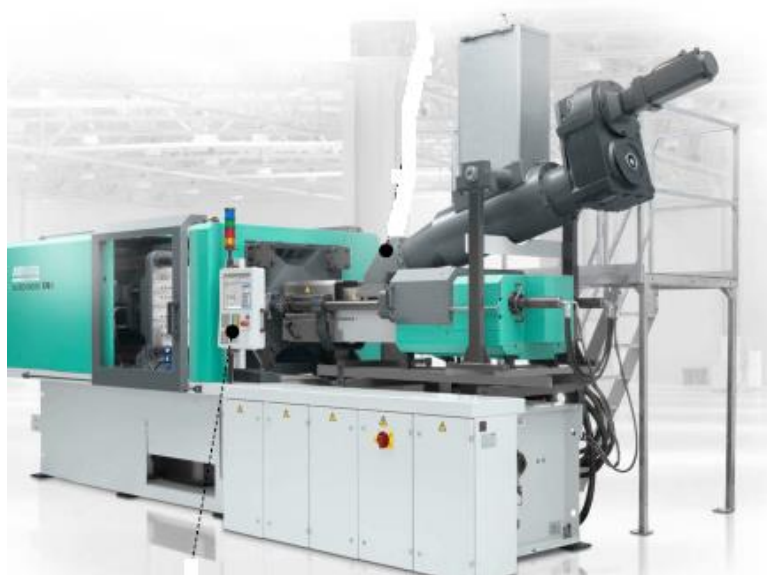
Слика 6.2.1 Машина „ALLROUNDER“ која даје велику слободу у дизајнирању металних и керамичких делова
