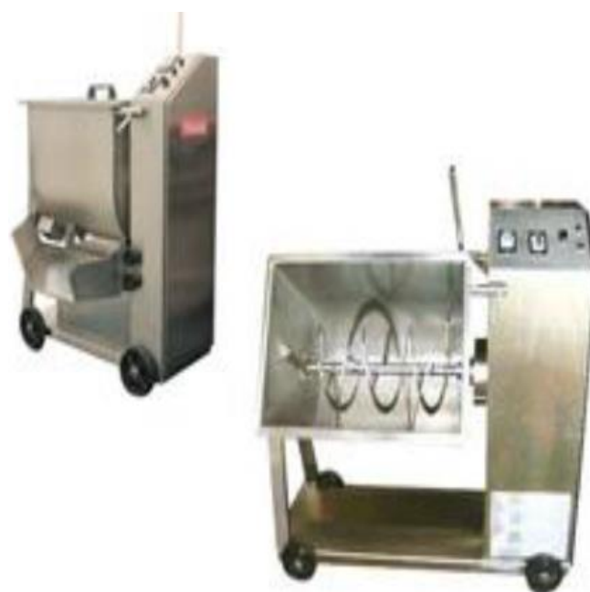
Слика 7.6.1. Машина за мешање праха модела „Ribbon Blender“ [16]
