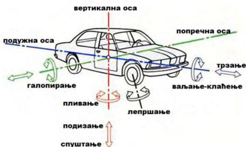
Слика 13: Приказ претпостављених и предвиђених кретања маса возила [2]
