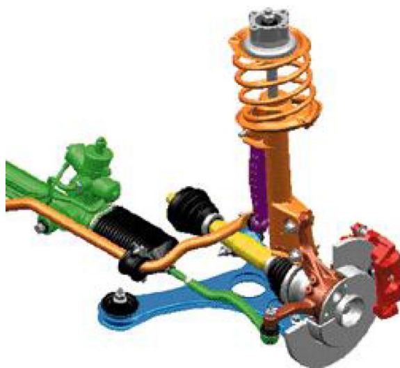
Слика 31: Макферсон ослањање на возилу Mercedes - Benz A - class [3]
