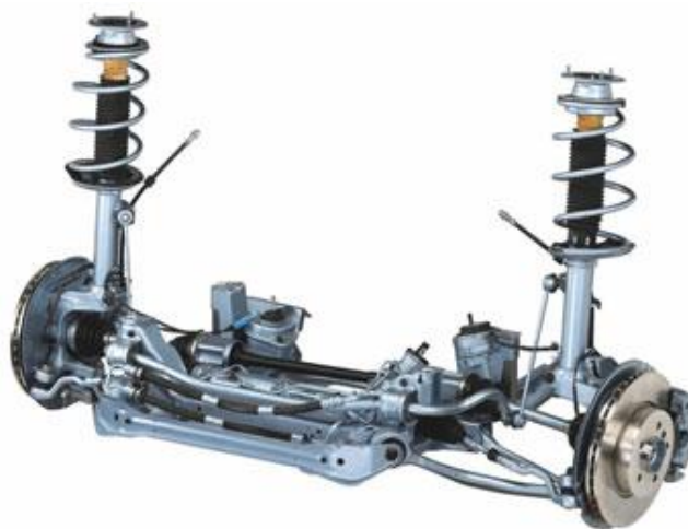
Слика 36: Макферсон са разложеним доњим вођицама [5]
