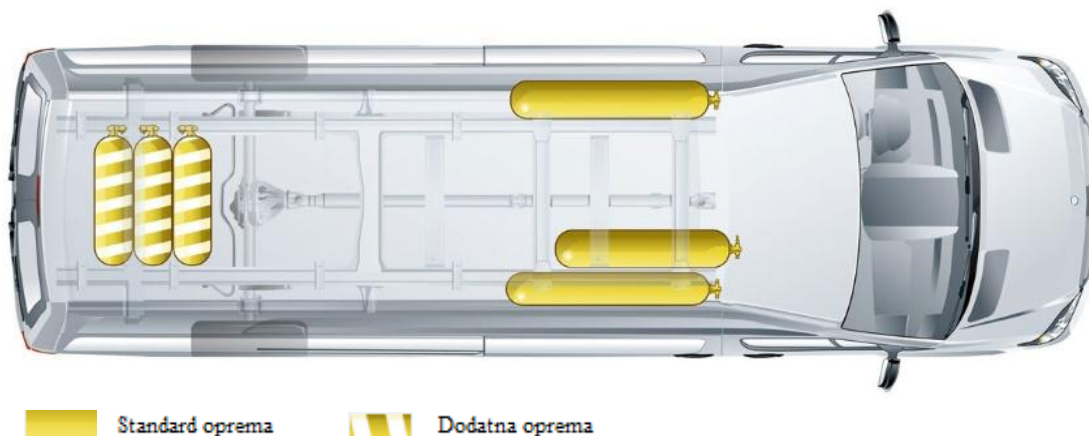
Слика 15. „Underfloor“ дизајн Sprintera NGT [37]
