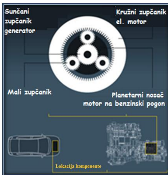
Слика 25. Power split device [20]
