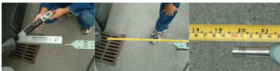
Слика 33 - Пример одређивања позиције микрофона при мерењу спољашње буке возила [11]
