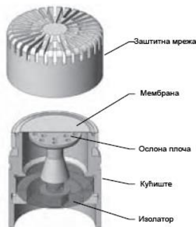
Слика 24 - Основни елементи капацитивног микрофона [21]
