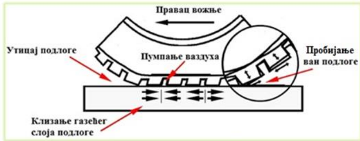
Слика 11 – Механизми генерисање буке пнеуматика [7]
