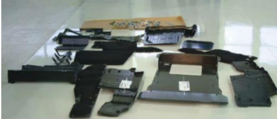
Слика 13 – Комплет делова за звучну изолацију погонске групе мотора припремљен за уградњу у теретно возило [11]
