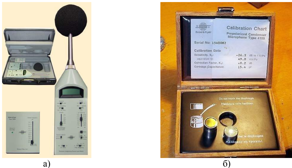
Слика 28 – Опрема за мерење буке: а) прецизни интеграциони фонометар Brüel&Kjær 2230, б) микрофон Brüel&Kjær 4155
