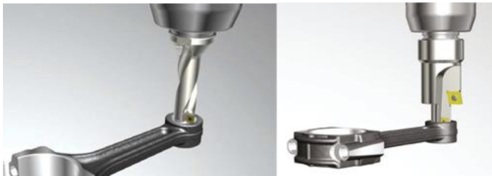
Слика 31 Бушење мањег отвора клипњаче на пред меру, а затим глодање[17]
