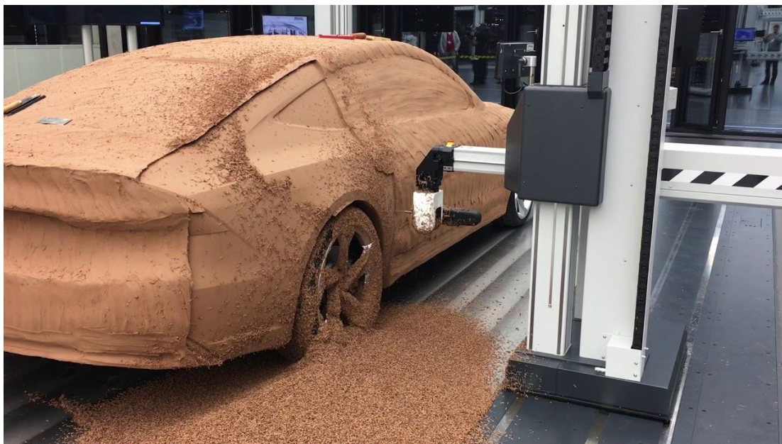
Слика 20 CNC израда макете новог аутомобила од индустријског пластелина-пластицина[14]
