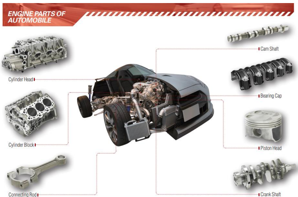
Слика 16 Компоненте мотора које се израђују обрадом резањем[17]
