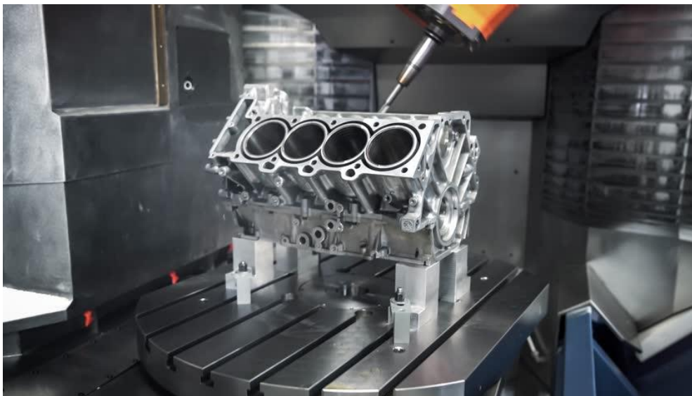
Слика 22 Израда блока мотора на петоосној CNC глодалици[15]
