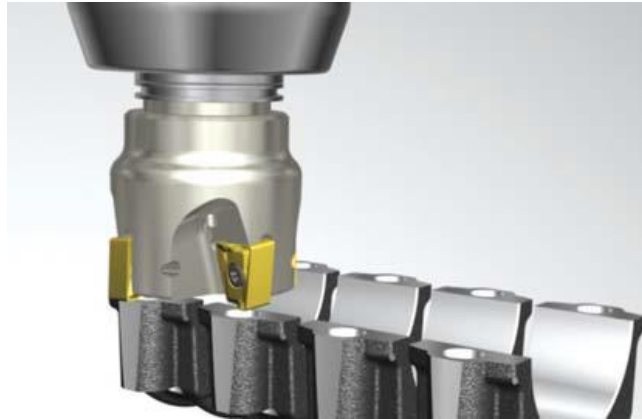
Слика 29 Обрада глодањем пресечених површина[17]
