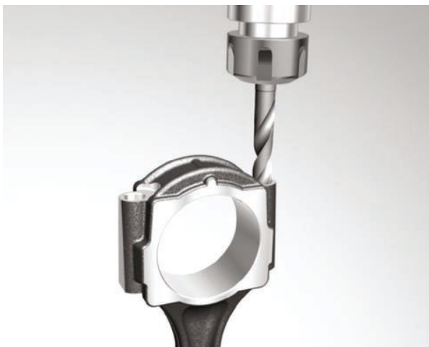
Слика 27 Бушење пролазне рупе за завртањ[17]
