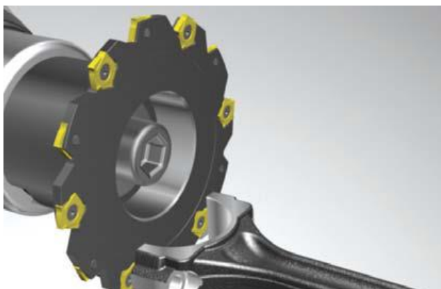
Слика 28 Расецање већег пречника клипњаче[17]
