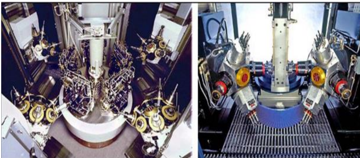
Слика 13 Приказ кружне CNC машине са више глава произвођача Kaufmann[9]
