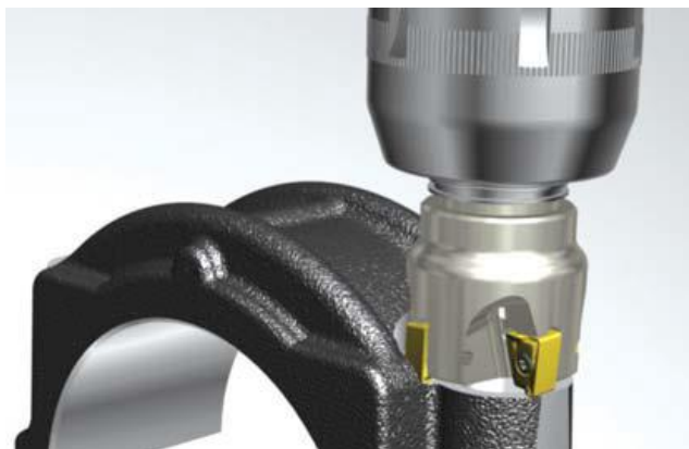
Слика 26 Обрада површина за завртањ глодањем[17]
