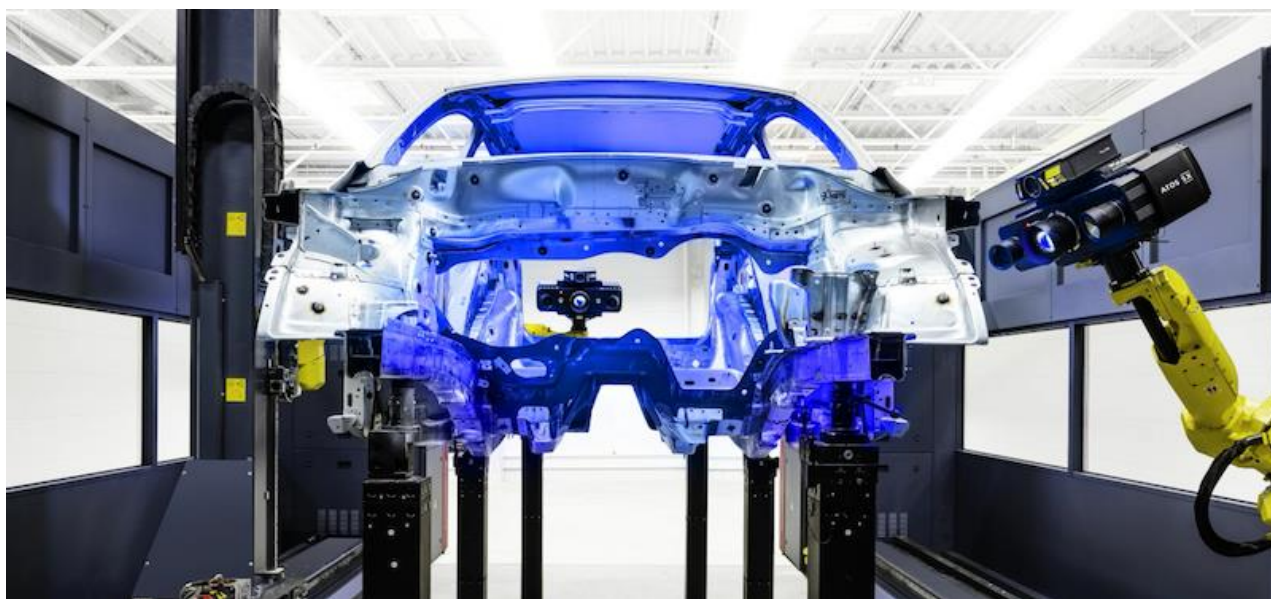
Слика 15 Напредна технологија сензорског мерења сензорима GOM Atos 5X[11]
