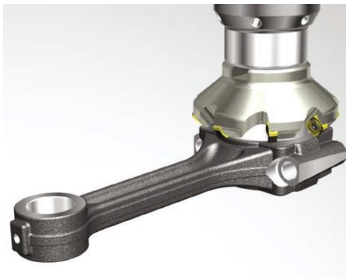
Слика 25 Завршна обрада страница већег пречника клипњаче глодањем[17]
