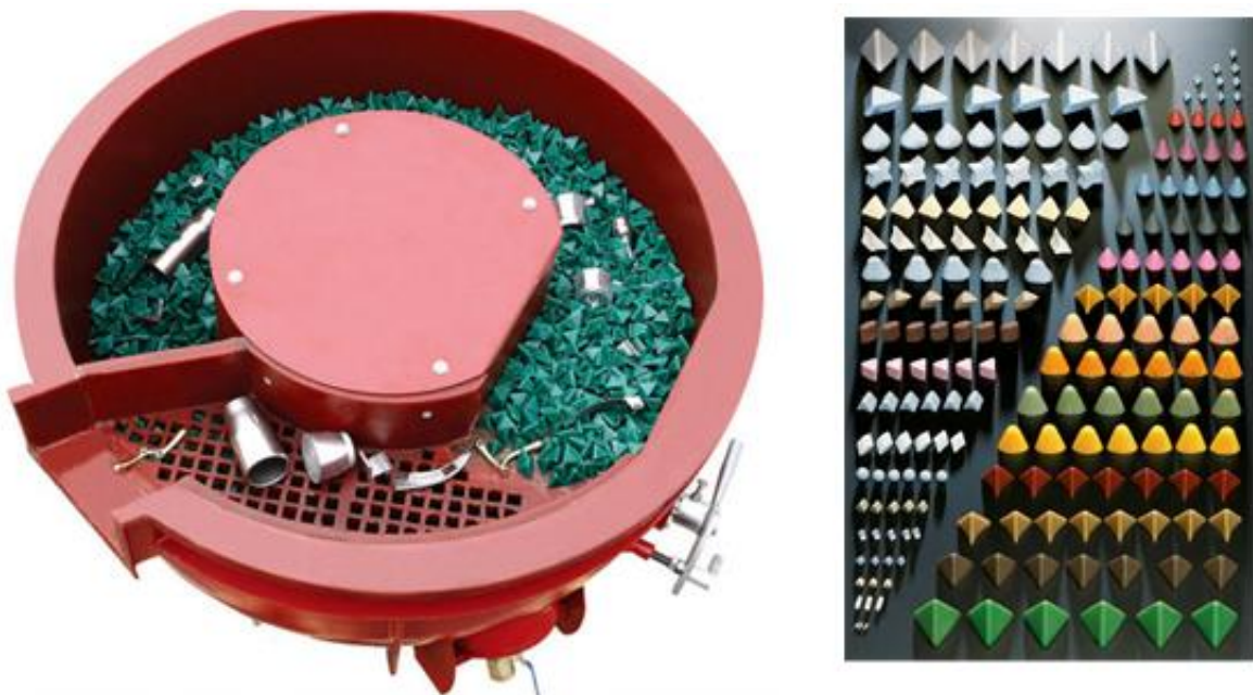
Слика 7.6 Уређај за вибрационо полирање и различита брусна тела од пластике и керамике [1]
