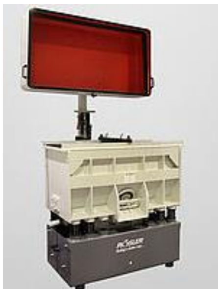
Слика 5.8 Коритасти вибратор [7]
