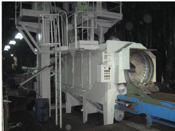
Слика 6.25 Бубњасте уређаји за пескарење са челичном траком [9]
