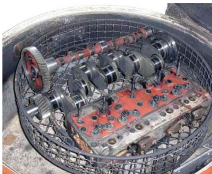
Слика 3.4 Простор за убацивање делова који се перу [6]
