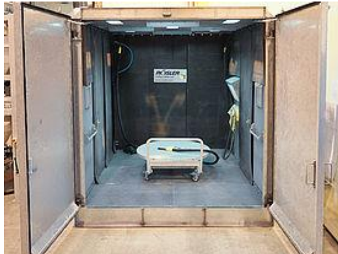
Слика 5.6 Слободан простор за пескарење [7]
