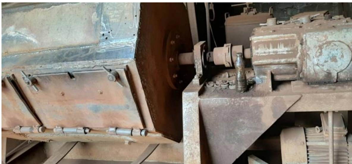
Слика 6.31 Погонски агрегат и веза између агрегата и радног дела уређаја
