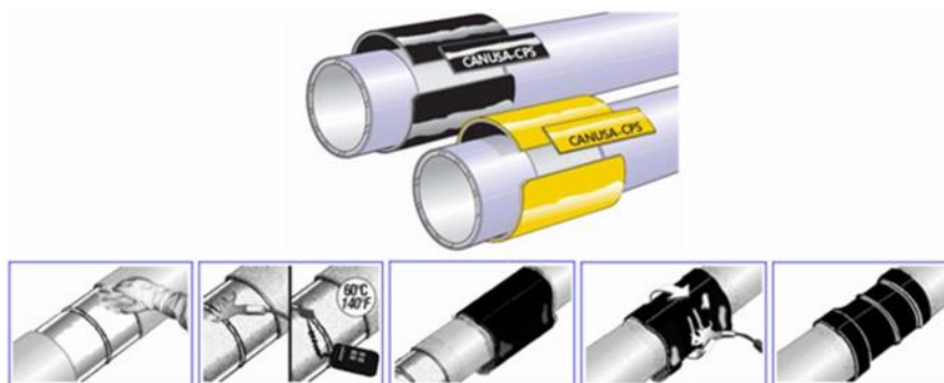
Слика 13.3 Пример обујмица при санацији цевовода
