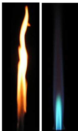
Слика 13.7 Приказ пламена код дифузионог (лево) и кинетичког (десно) горионика
