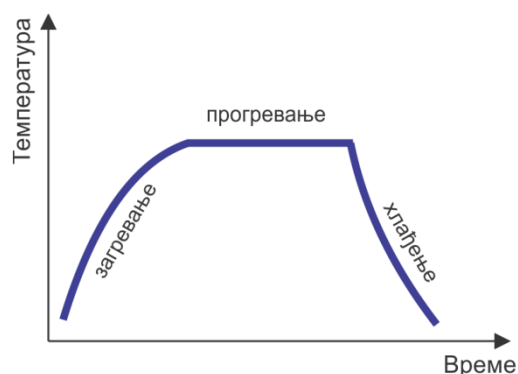
Слика 1.1. Ток извођења процеса термичке обраде
