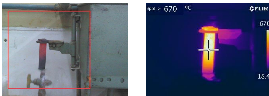
Слика 8.33. Процес чеоног хлађења приказана термовизијски са датом температуром
