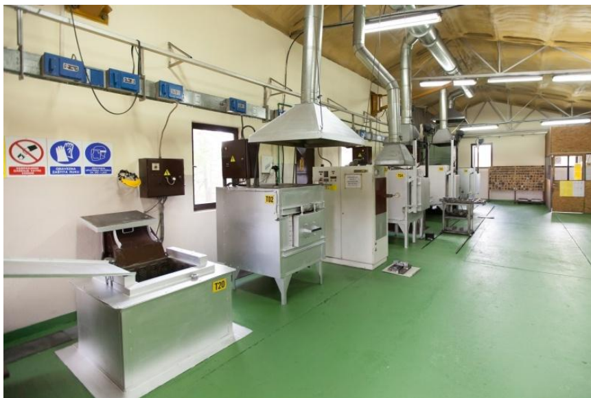
Слика 7.16. Пример модерног постројења за термичку обраду (каљење+отпуштање)
