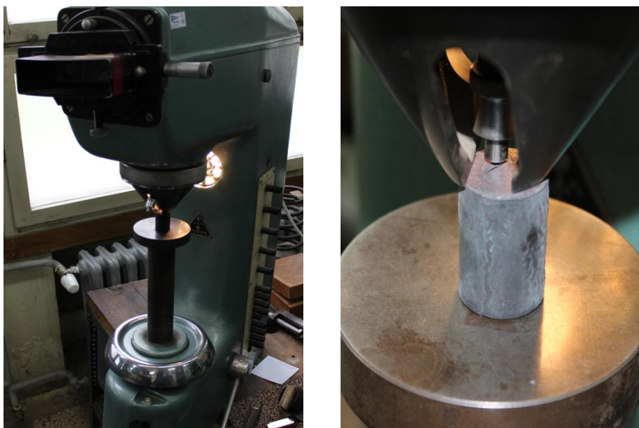
Слика 8.9. Мерење тврдоће по Викерс методи
