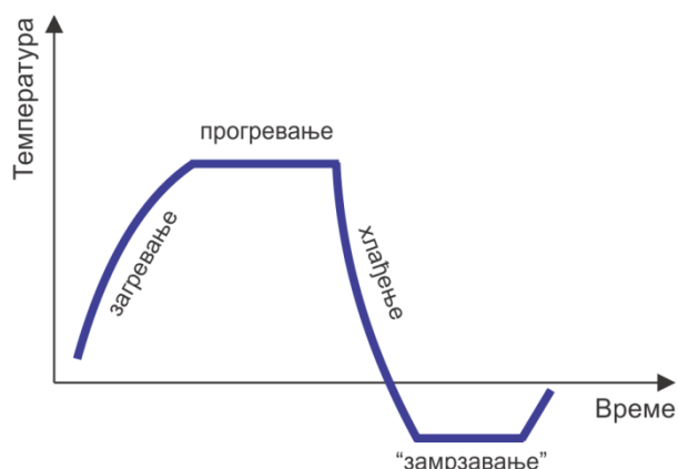
Слика 1.2. Ток термичке обраде са хлађењем испод 0^{\circ}\text{C}
