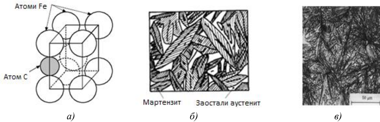
Слика 2.8. а) кристална решетка мартензита, б) структура закаљеног челика, в) микроструктура мартензита
