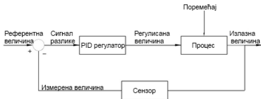
Слика 7.6– Управљање системом ослањања по једном излазу (по деформацији СЕО) [10]
