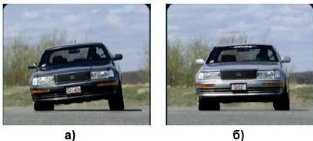
Слика 6.10 – Реакције возила при уласку у кривину: а) стандардан систем ослањања са амортизером, б) са линеарним електромагнетним ослањање [7]
