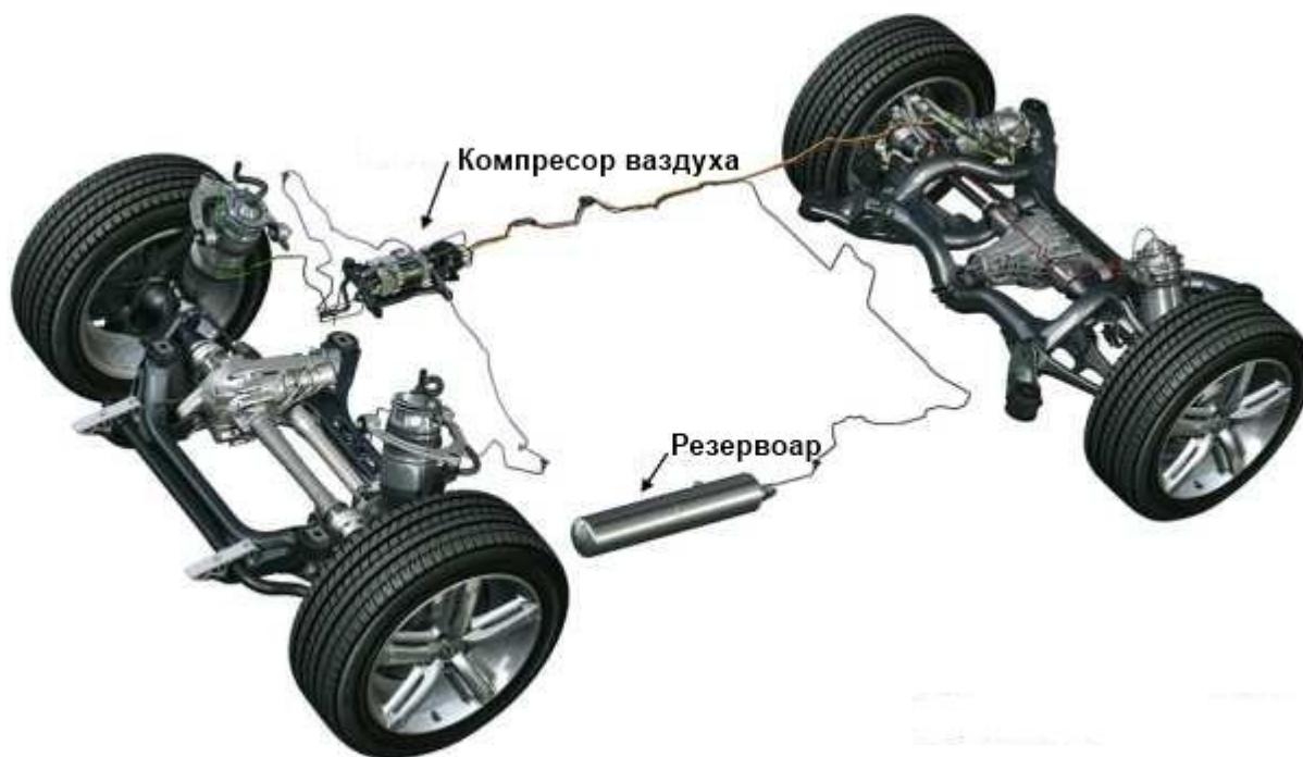
Слика 3.11 – Ваздушно ослањање возила VW Touareg [6]
