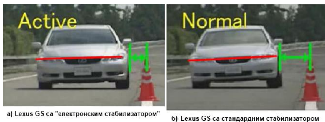
Слика 5.16 – Понашање аутомобила Lexus GS при заокретању предњих управљачких точкова и дејства момента увијања на предњу осовину са стандардним и електронски контролисаним стабилизатором [25]
