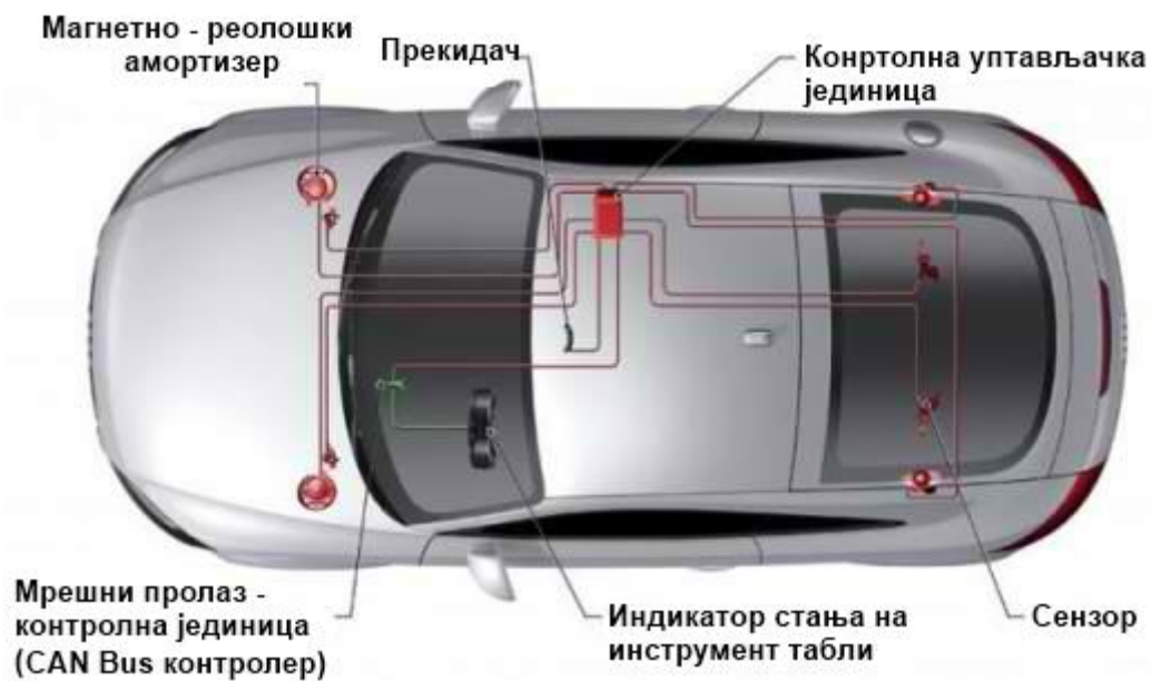
Слика 4.10 – Полуактивни СЕО на возилу Audi TT [16]
