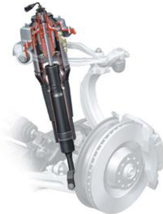
Слику 5.10 – Активно ослањање предње осовине код возила Audi A8 [21]
