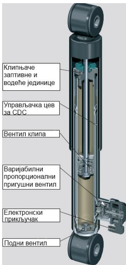
Слика 5.20 – CDC пригушивач фирме ZF [26]
