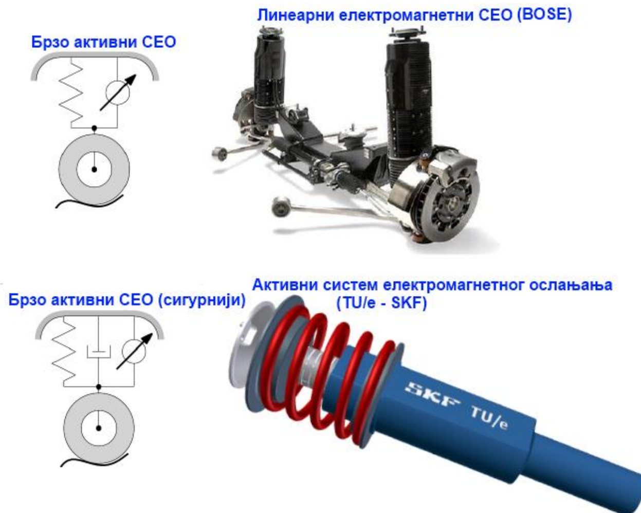
Слика 6.11 – Осцилаторни модели ослоњене масе за линеарно електромагнетно ослањања возила (BOSE) и активни систем електромагнетног ослањања (TU/e - SKF) [30]
