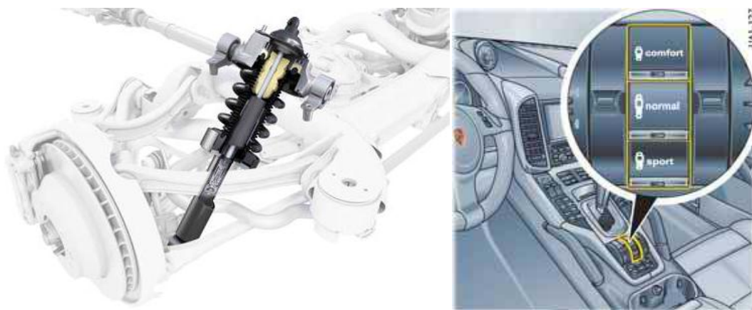
Слика 5.12 – Лево: PASM активно ослањање на задњој погонској осовини, Десно: модови за одабир режима ослањања код Porsche-a 911 GT3 [24]
