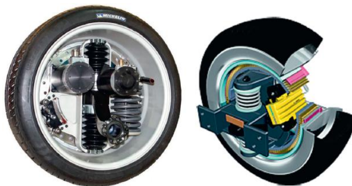
Слика 4.17 – Примери „full – corner“ технологије активног точка, произвођача Michelin (лево) и Siemens (десно) [2]
