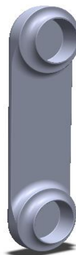
Слика 5.5 3Д модел носача зупчаника пумпе
