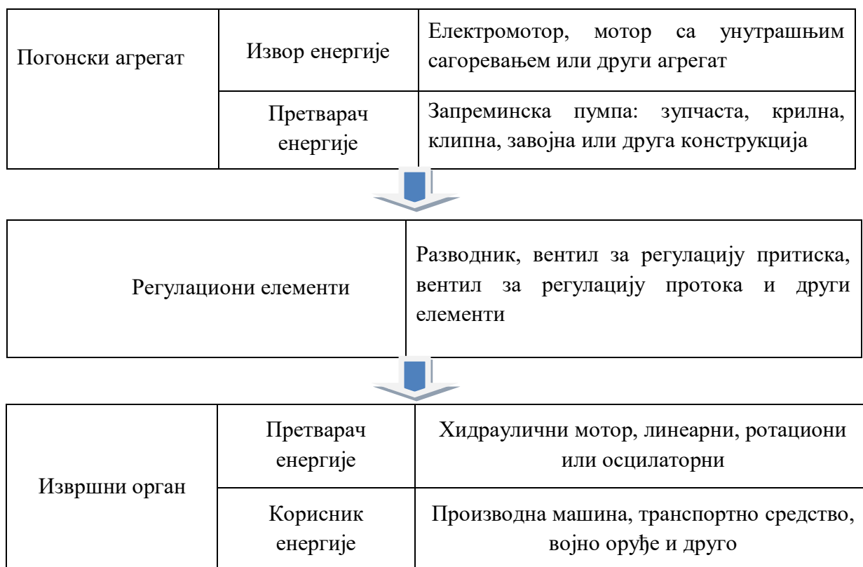
Слика 1.1 Принципијална блок шема хидрауличног система [1]
