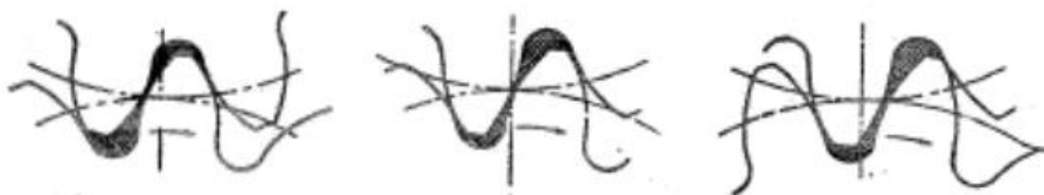
Слика 4.6 Шема транспорта уља кроз међузубља
