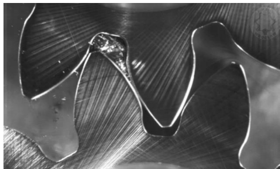
Слика 4.9 Пример настанка кавитације при спрезању зупчаника
