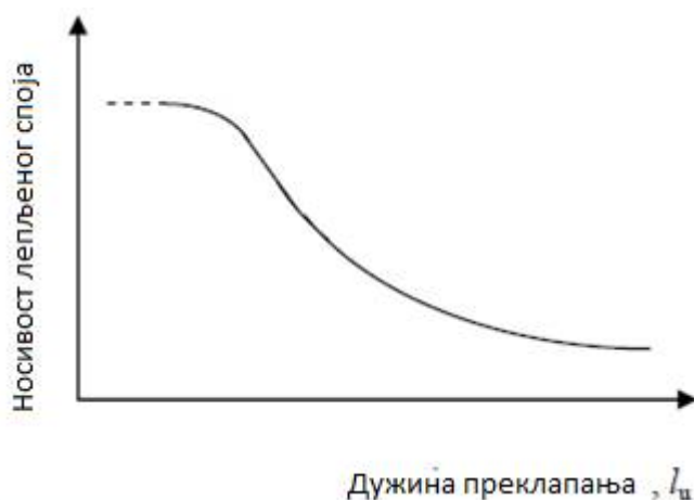
Слика 3.9 Зависност носивости лепљеног споја од дужине преклапања [14]
