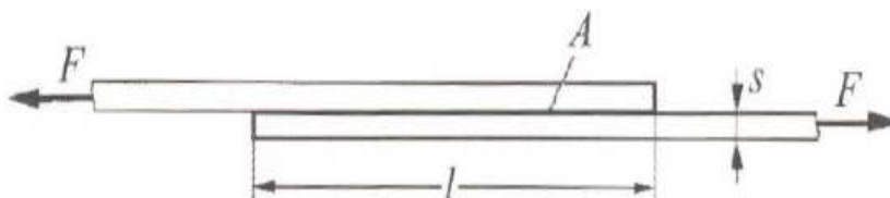
Слика 3.10 Лепљени преклопни спој лимова, A-површина лепљеног споја; l- дужина; s- дебљина лима [17]
