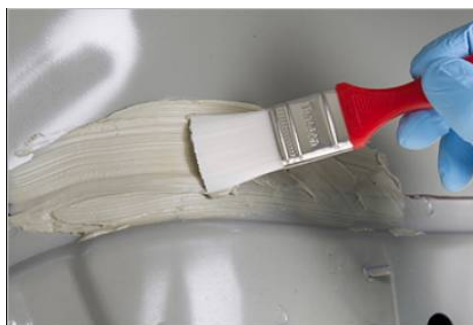
Слика 3.7 Ручно наношење лепка четком [10]
