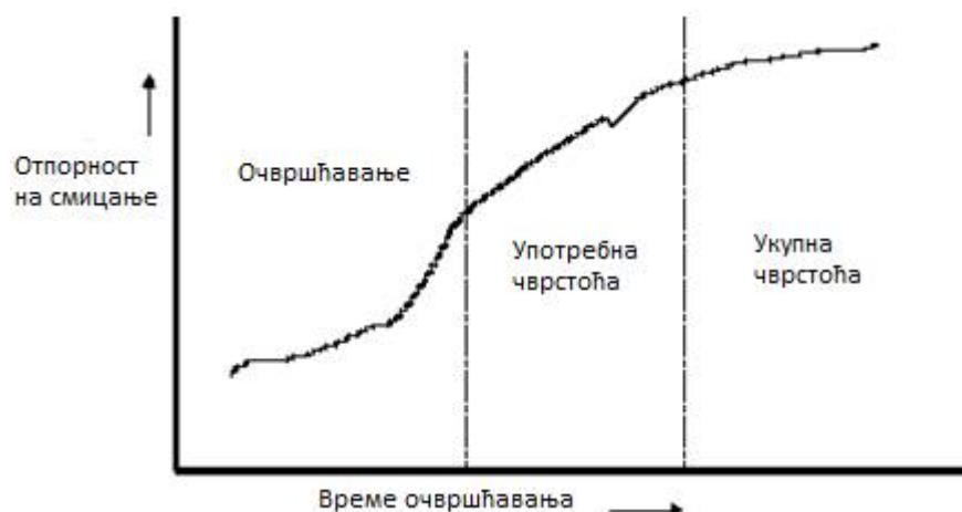
Слика 2.10 Крива очвршћавања једнокомпонентног лепка на собној температури [18]
