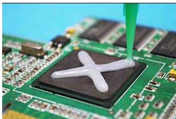
Слика 5.8 Термички проводљив лепак се наноси за лепљење хладњака у индустрији електронике[41]
