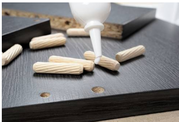
Слика 5.6 Наношење лепка на дрвене клинове при спајању намештаја[43]
