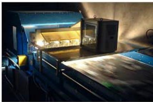
Слика 4.12 Уређај за НИР спектроскопију [6]
