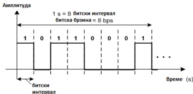
Слика 9. Битски интервал (трајање једног бита).
