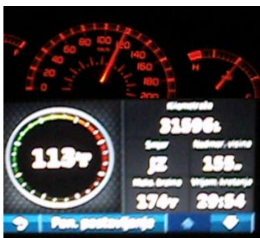
Слика 27. Приказ поређења приказа брзине кретања возила на GPS уређају и брзиномеру
