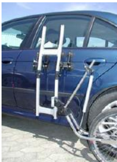
Слика 3. Различите везе петог точка са возилом: а) адаптер за вучну куку, б) адаптер за вучно око, в) "Н" адаптер са пнеуматским хватаљкама за бок возила, г) адаптер за везу са шипком испод пода возила, д) адаптер за заштитну шипку од подлетања [5]
