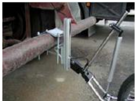
Слика 3. Различите везе петог точка са возилом: а) адаптер за вучну куку, б) адаптер за вучно око, в) "Н" адаптер са пнеуматским хватаљкама за бок возила, г) адаптер за везу са шипком испод пода возила, д) адаптер за заштитну шипку од подлетања [5]
