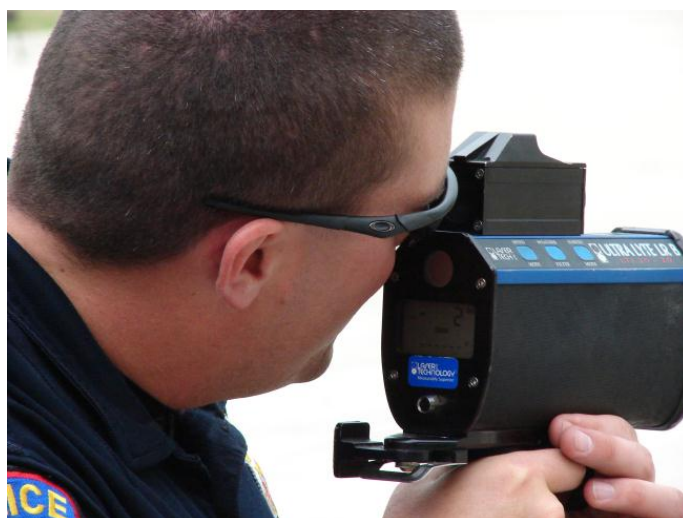
Слика 8. Примена лидара при мерењу брзине (модел „LTI-20/20 Ultra Lyte Laser“)
