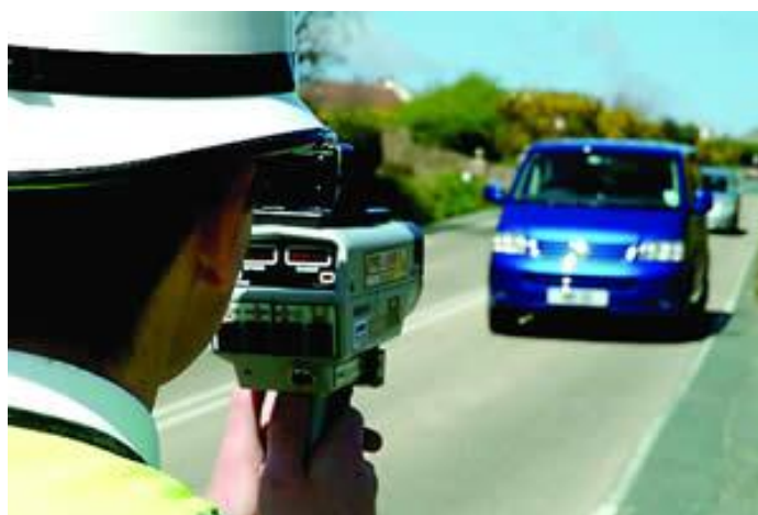
Слика 4. Употреба ручних радара за контролу брзине кретања возила
