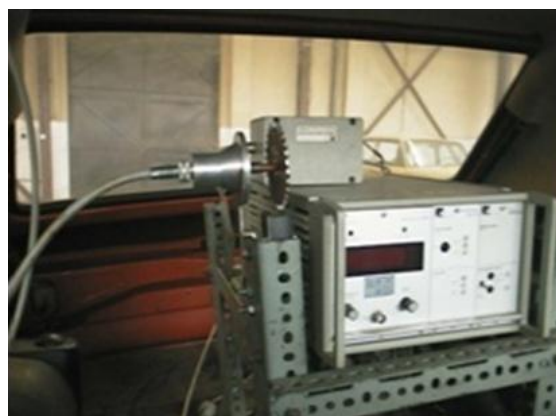
Слика 16. Мерни ланац за мерење броја обртаја точка [4]
