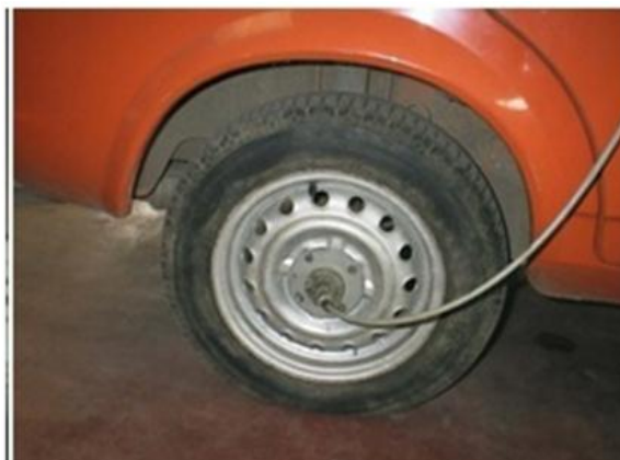
Слика 15. Мерење броја обртаја точкова [4]
