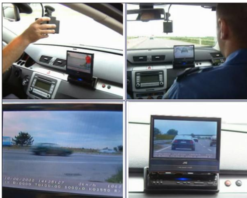
Слика 7. Систем за мерење брзине кретања возила VASCAR 5000 [6]
