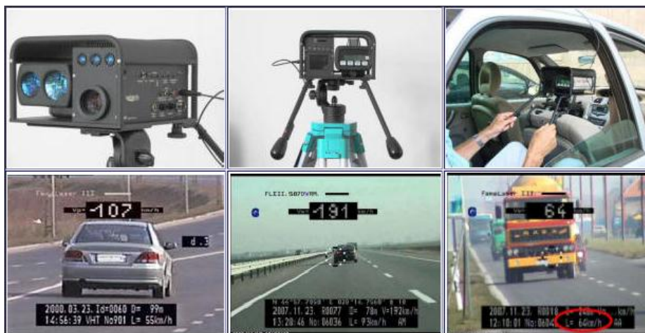
Слика 9. Ласерски уређај за мерење брзине кретања „Fama laser III“ [6]
