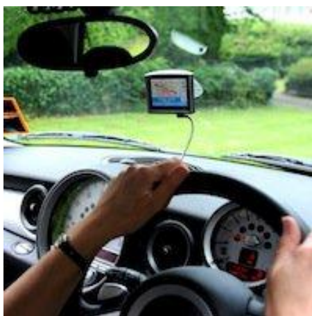
Слика 24. Истовремено мерење брзине кретања помоћу брзиномера и GPS уређаја
