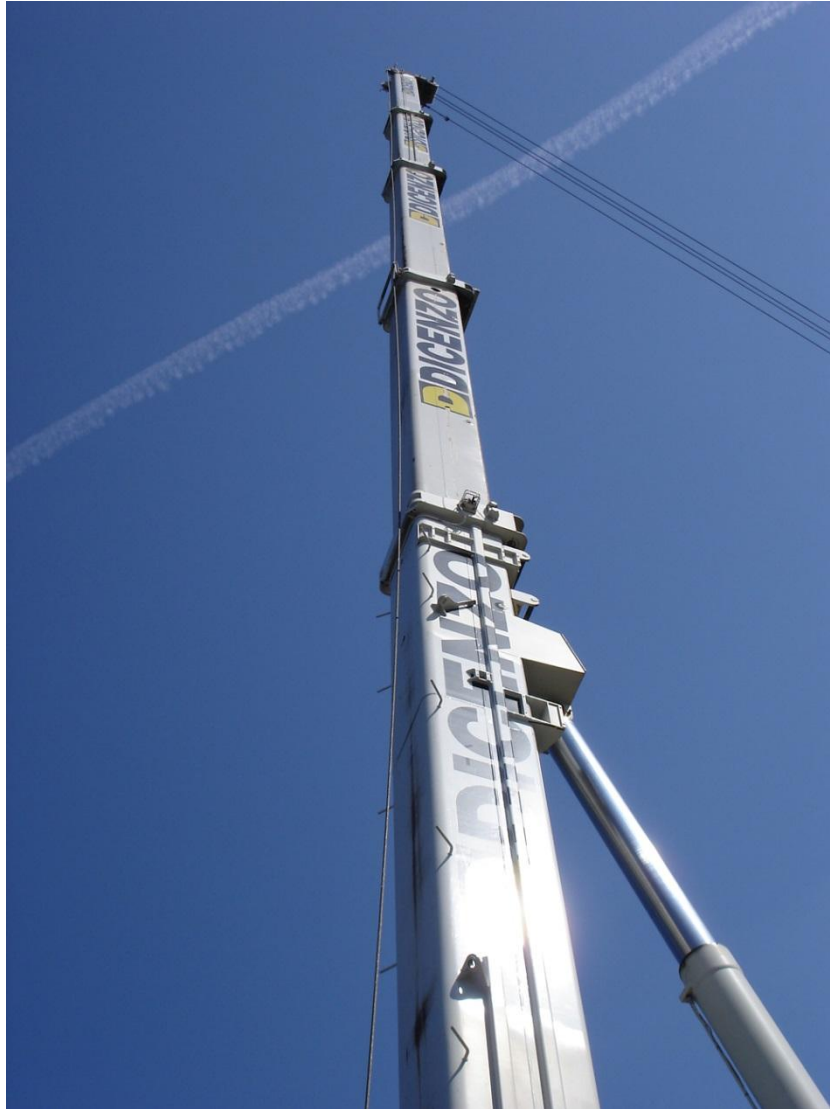
Слика 5.2 Телескопска стрела [11]
