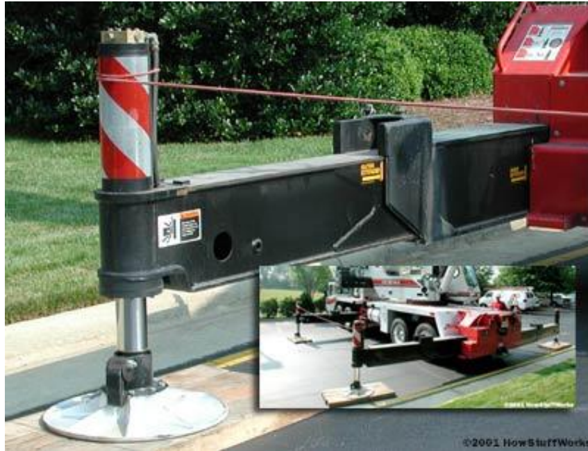
Слика 6.12 Мерење притиска у стабилизацијској нози А на месту Е [14]
