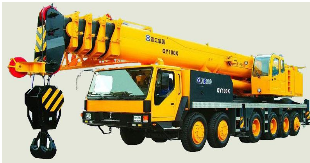
Слика 2.6 Аутодизалица са телескопском стрелом [4]
