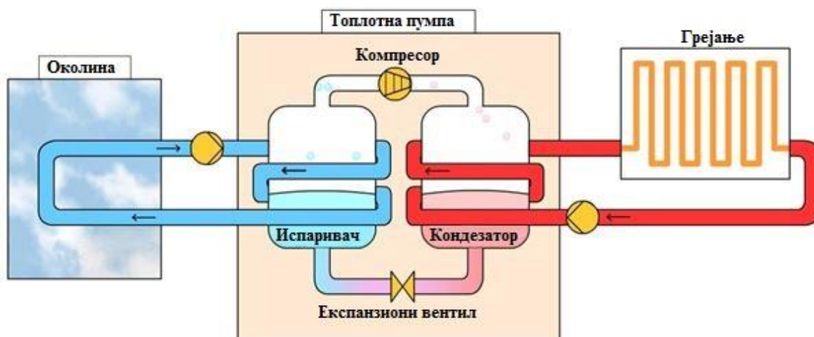
Слика 7. Кретање топлотне енергије од извора до потрошача [6]
