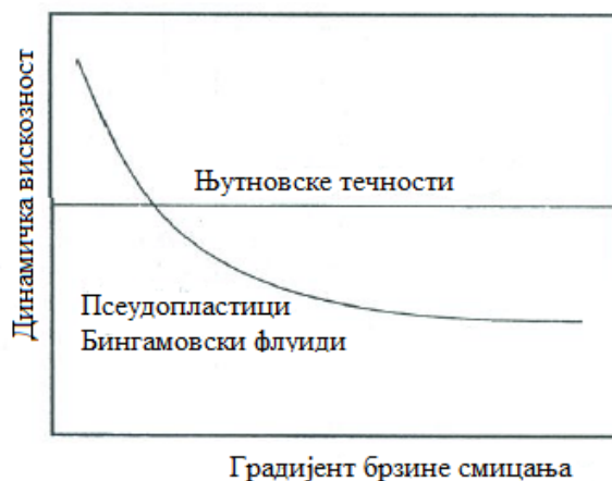
Слика 25. Зависност динамичке вискозности од градијента брзине смицања [23]
