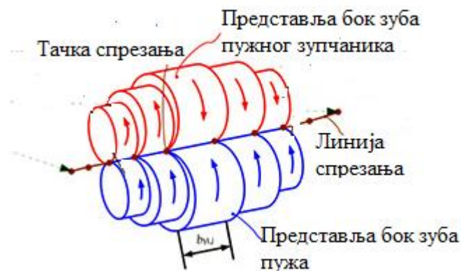
Слика 14. Упрошћени триболошки модел спрезања зуба пужног преносника [12]
