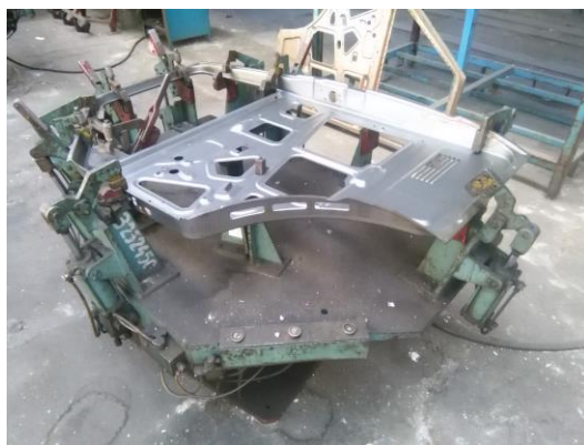
Слика 40. Стезни прибор који се користи у производњи
