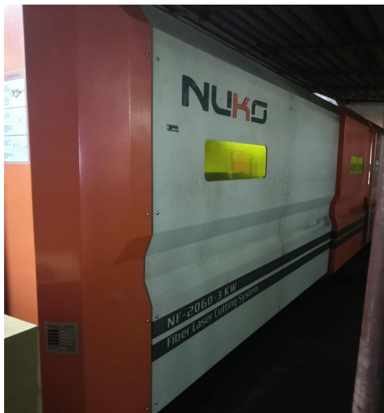
Слика 5. Фибер ласер за сечење лимова NUKON NF 2060-3kW
