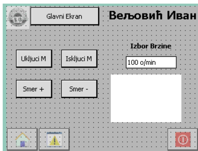
Слика 30 Изглед HMI екрана за контролу мотора
