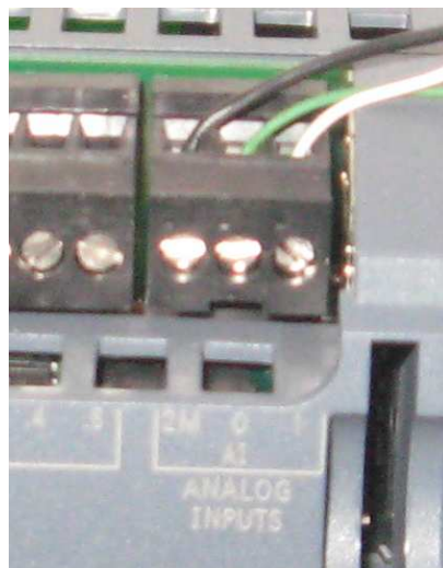
Слика 11 Повезивање аналогног улаза са сензором (црна-зелена дају разлику потенцијала 0-5VDC са мерача новео)
