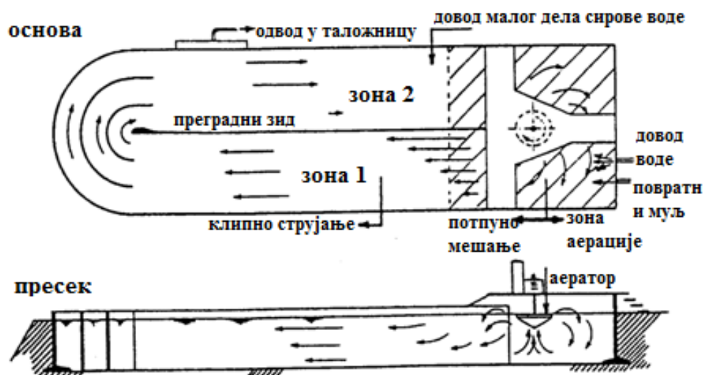
Слика 6.10. Шема постројења карусел
