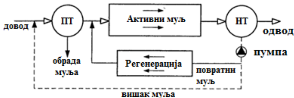
Слика 6.7. Шема процеса контактне стабилизације
