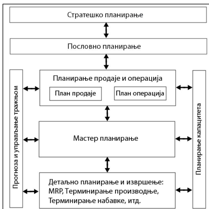
Слика 3. Архитектура пословних процеса ERP система. [3]
