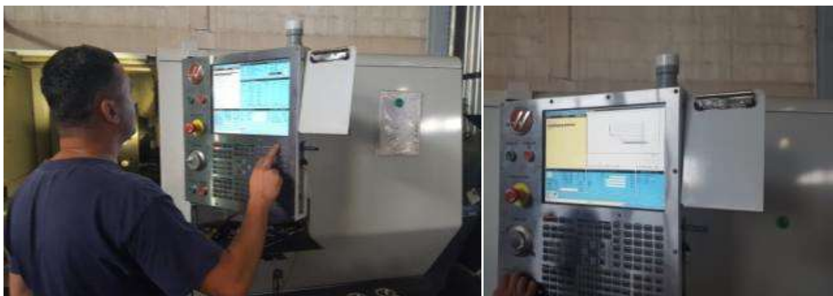
Слика 6.2: Корекција NC кода и извођење симулације на управљачкој јединици
