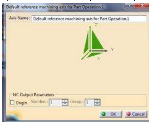
Слика 3.2.5: Дефинисање референтног координатног система
