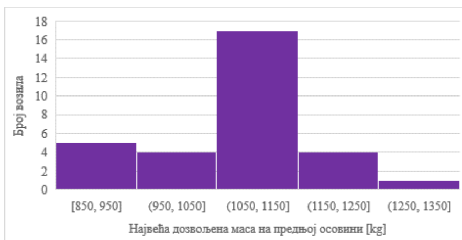
Слика 4.5 Вредности највеће дозвољене масе на предњој осовини различитих лимузина
