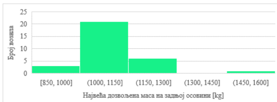
Слика 4.6 Вредности највеће дозвољене масе на задњој осовини различитих лимузина
