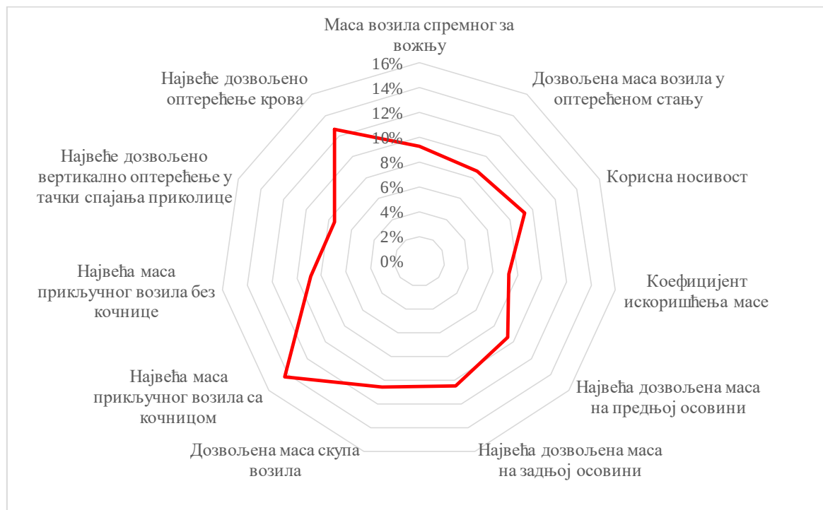
Слика 4.12 Одступања масених карактеристика лимузина од просечних вредности
