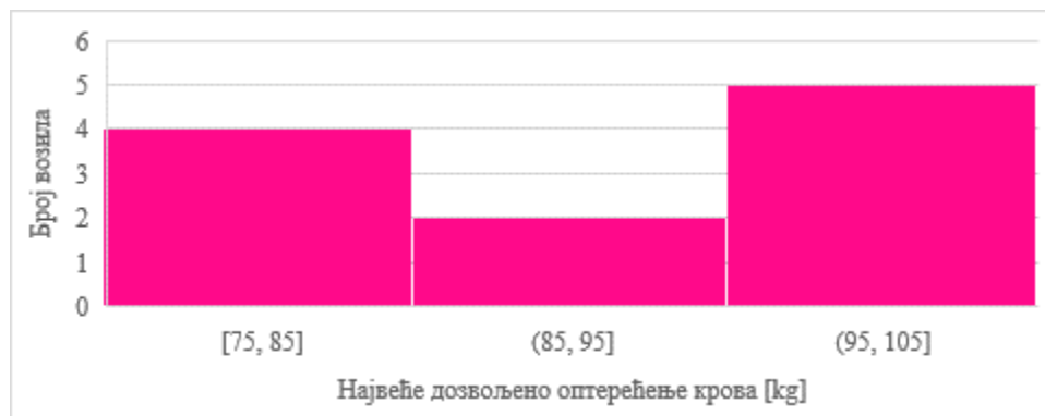
Слика 4.11 Вредности највећег дозвољеног оптерећења крова различитих лимузина
