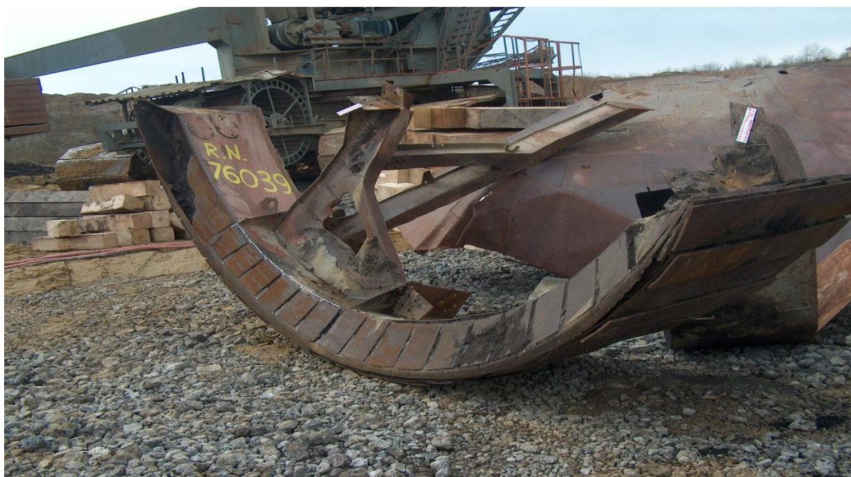
Слика 5- Стање полумесеца радног точка роторног багера СРС-400, као последица хабања
