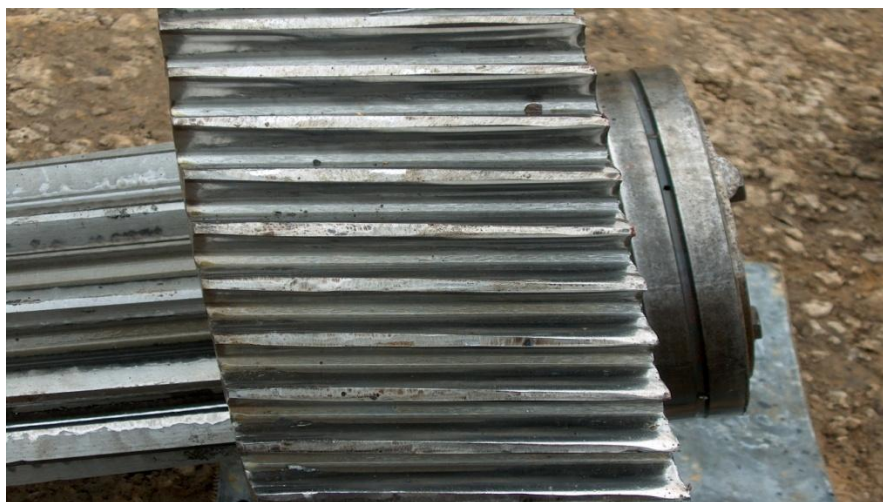
Слика 3- Оштећења зупчаника редуктора радног точка багера СРс-2000
