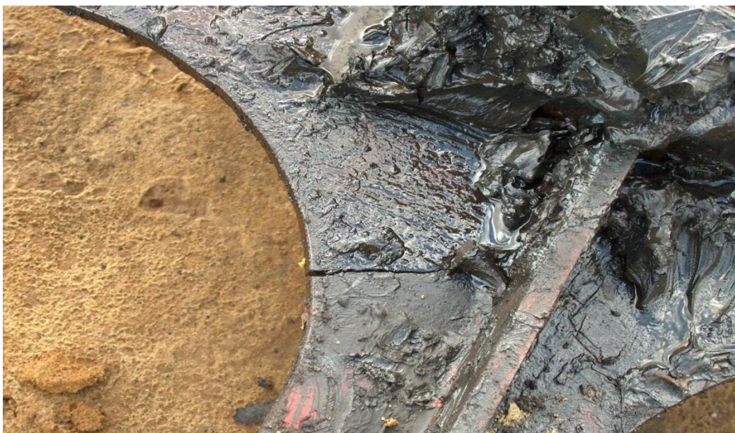
Слика 7- Оштећење основне конструкције багера ЕРс-710
