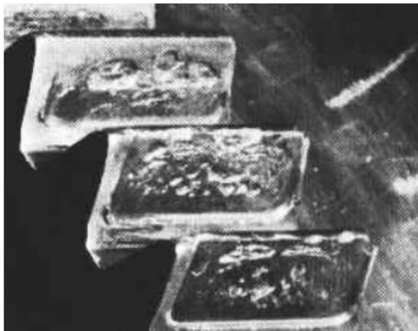
Слика 8. Атхезионо хабање зупчаника
