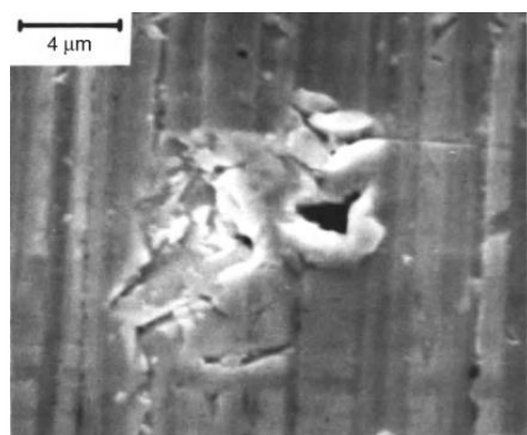
Слика 11. СЕМ микрографија површине вратила од нерђајућег челика након атхезионог хабања у условима неподмазивања, клизни правац је дуж вертикалне осе
