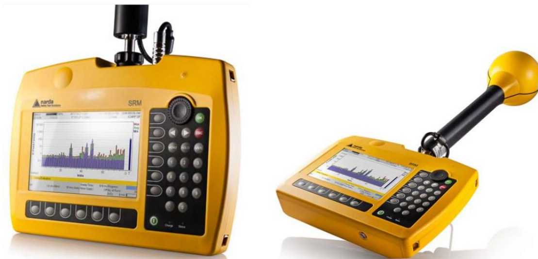
Слика 28. Сензор НАРДА SRM 3006 [10]
