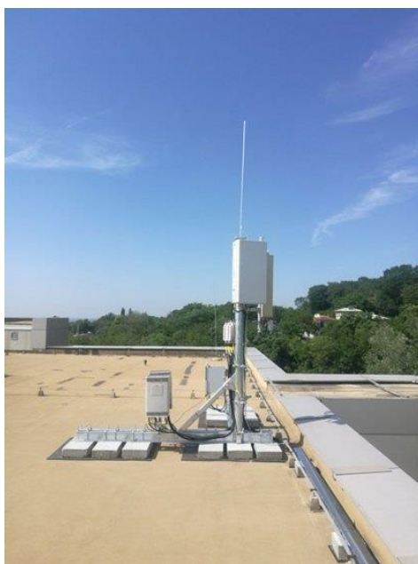
Слика 23. РАТЕЛ-ов сензор за праћење јачине електромагнетног поља под утицајем 5G мреже [9]
