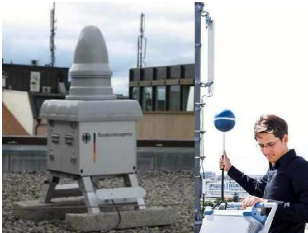
Слика 32. Сензор Rohde & Schwarz TS на постављеној локацији [10]
