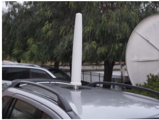
Слика 27 . НАРДА широкопојасни сензор на крову возила у функцији мобилног сензора [10]
