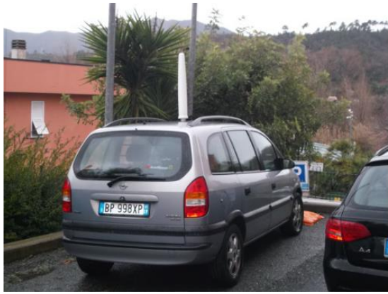
Слика 27 . НАРДА широкопојасни сензор на крову возила у функцији мобилног сензора [10]
