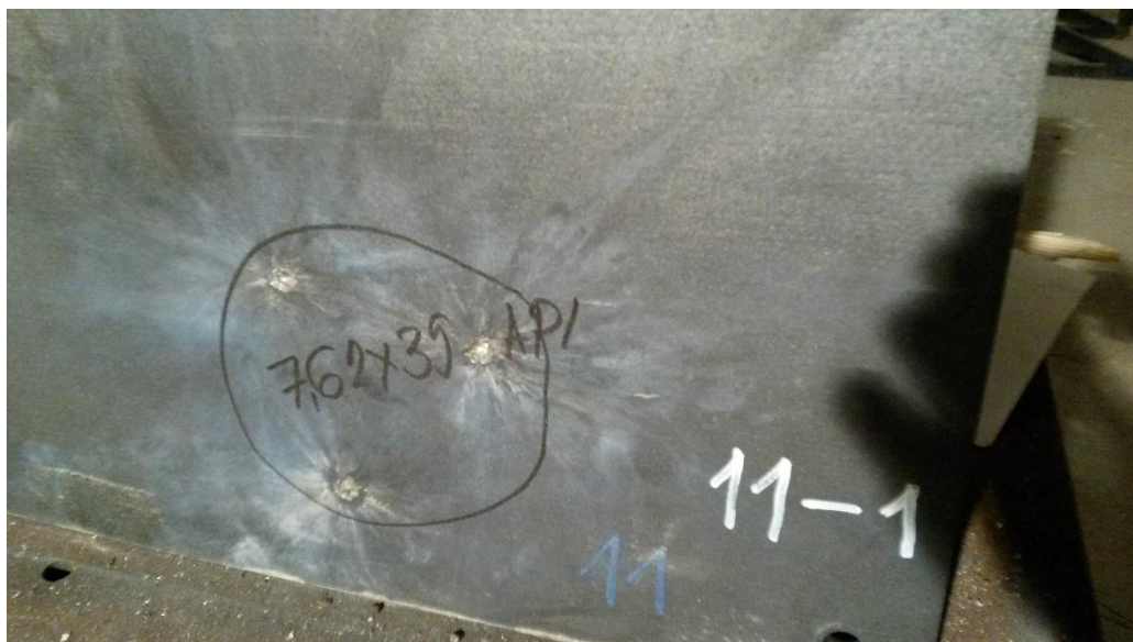
Слика 2.9 Плоча 11-1 након гађања
