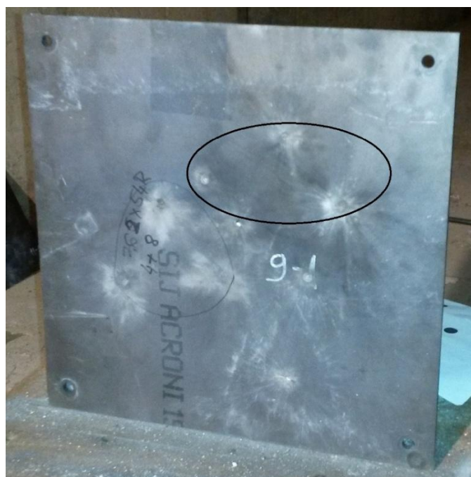
Слика 2.7 Плоча 9-1 након гађања
