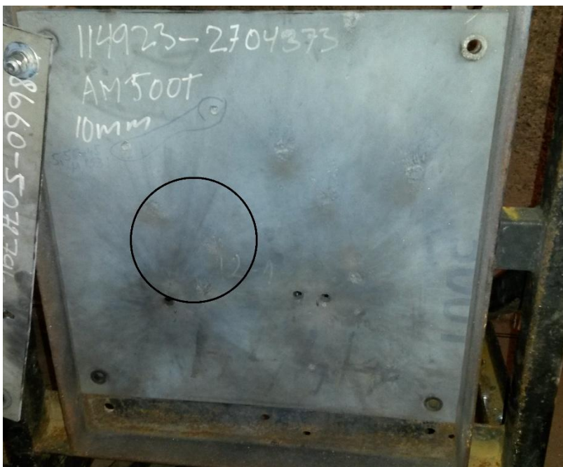
Слика 2.10 Плоча 12-1 након гађања
