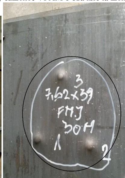
Слика 2.5 Плоча 3-1 након гађања а) предња страна б) задња страна
