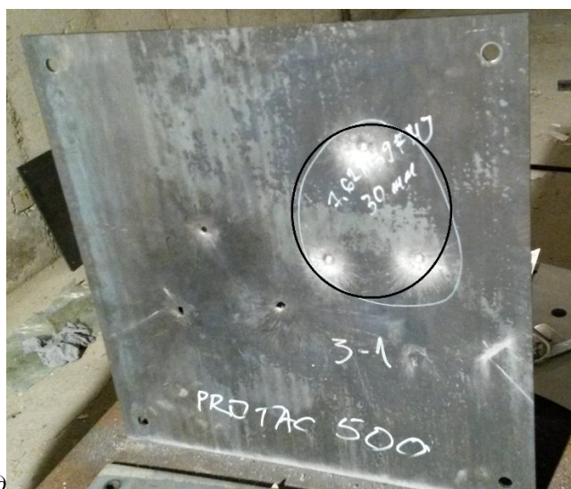
Слика 2.5 Плоча 3-1 након гађања а) предња страна б) задња страна
