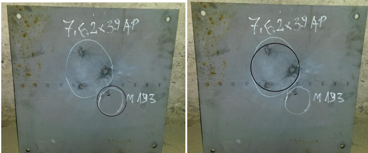
а) б) Слика 2.6 Плоча 8-1 након гађања а) 5,56x45 mm M193 б) 7,62x39 API
