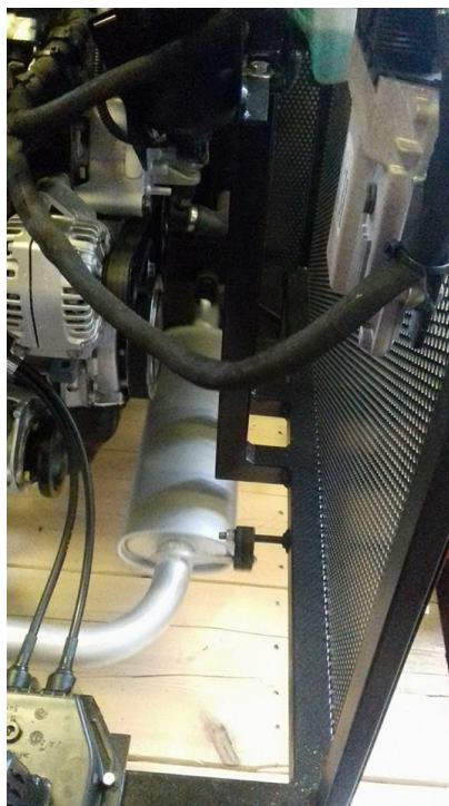
Слика 4.14. Постављање сонде у издувни систем дизел мотора
