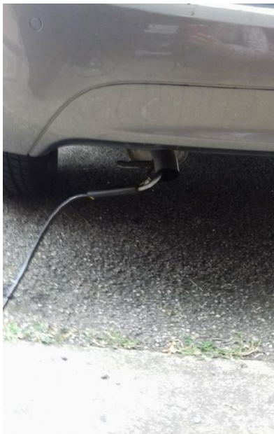
Слика 4.9. Постављање сонде у издувну цев возила
