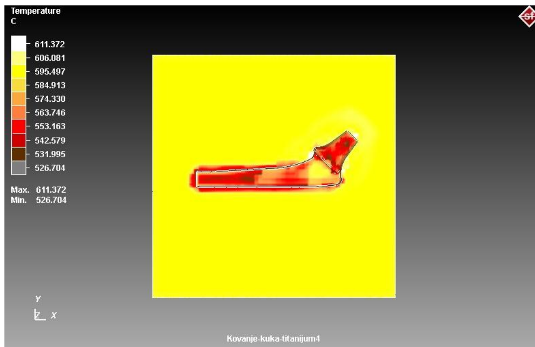
Слика 65. Расподела температуре доњег алата
