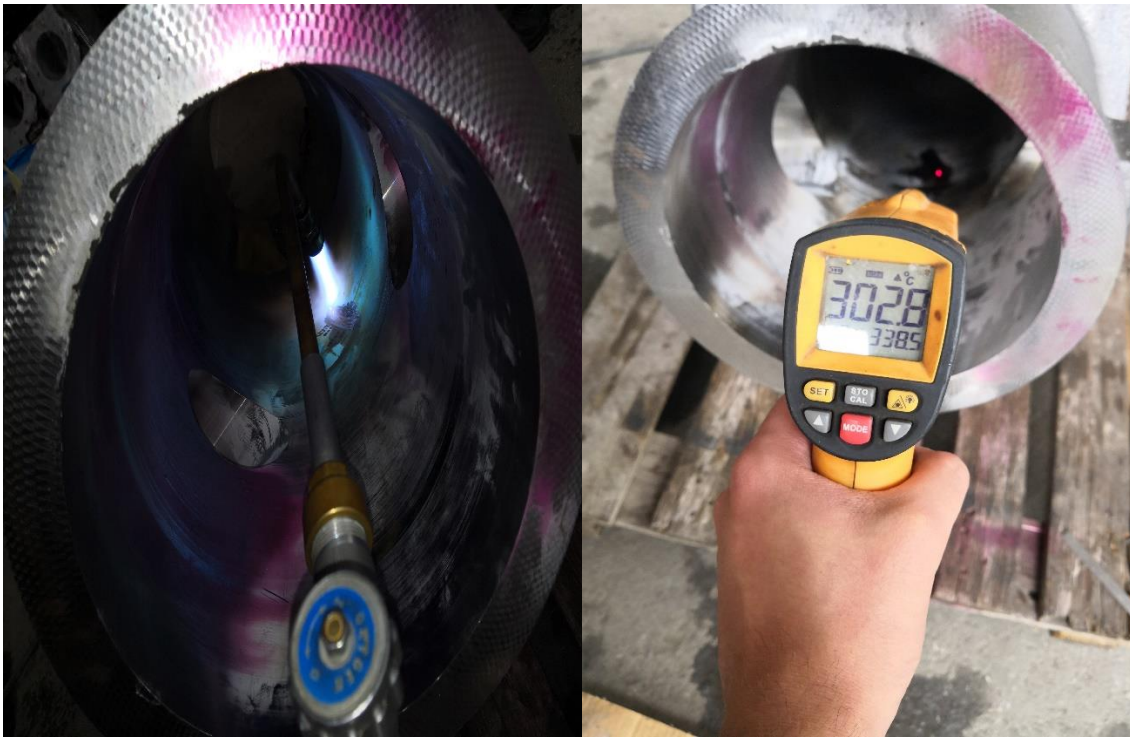
Слика 6.12 Предгревање колевке и контрола температуре у зони дораде
