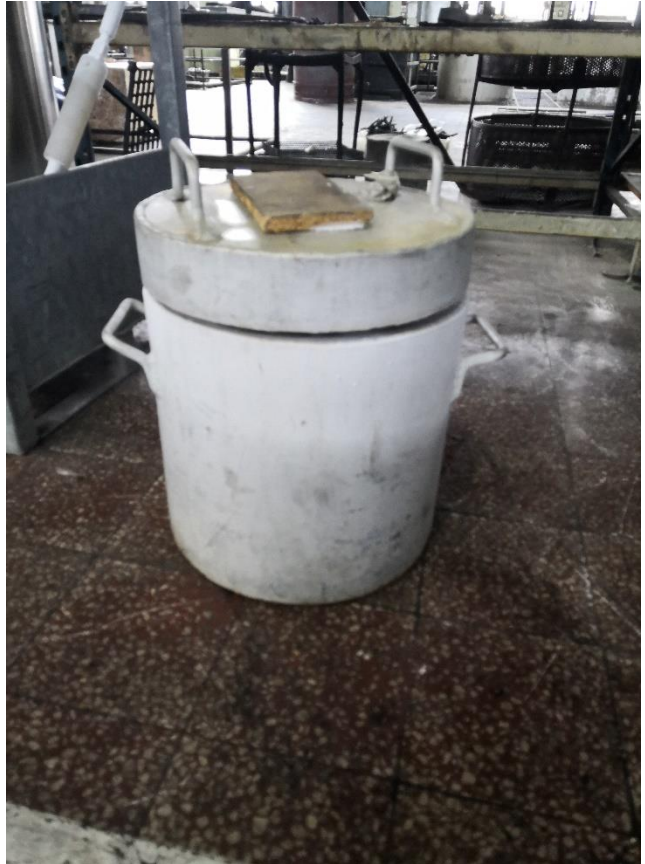
Слика 6.15 Опрема за хлађење течним азотом
