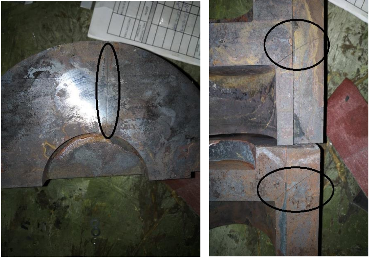
Слика 4.2 Прслине после каљења
