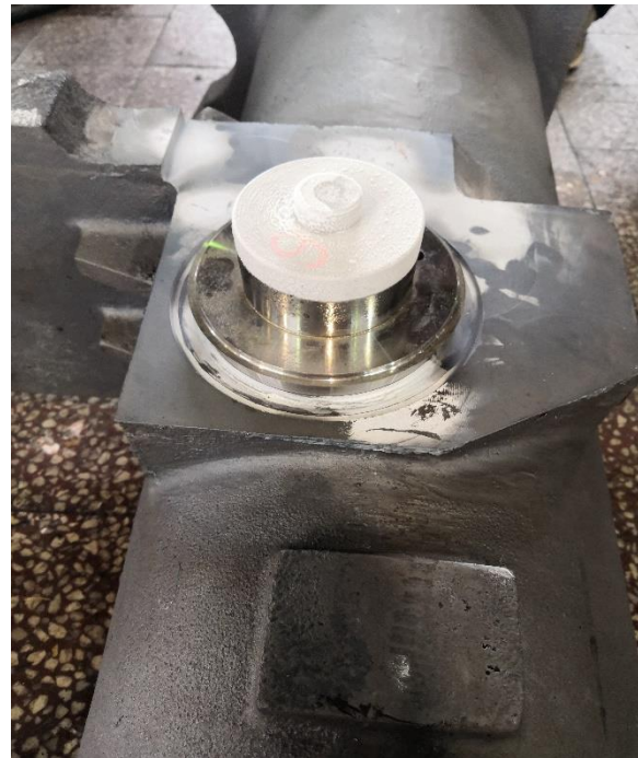
Слика 6.18 Процес изједначавања температура пресованих делова - остваривање чврстог пресованог склопа
