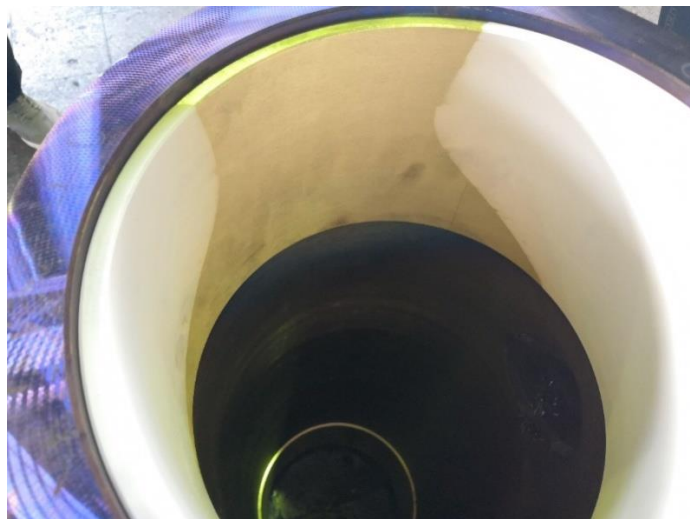
Слика 6.21 Изједначавање температура (остваривање чврстог пресованог склопа)
