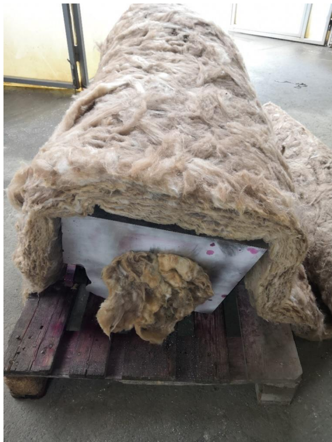
Слика 6.14 Покривање целог дорађеног одливка термоизолационим материјалом
