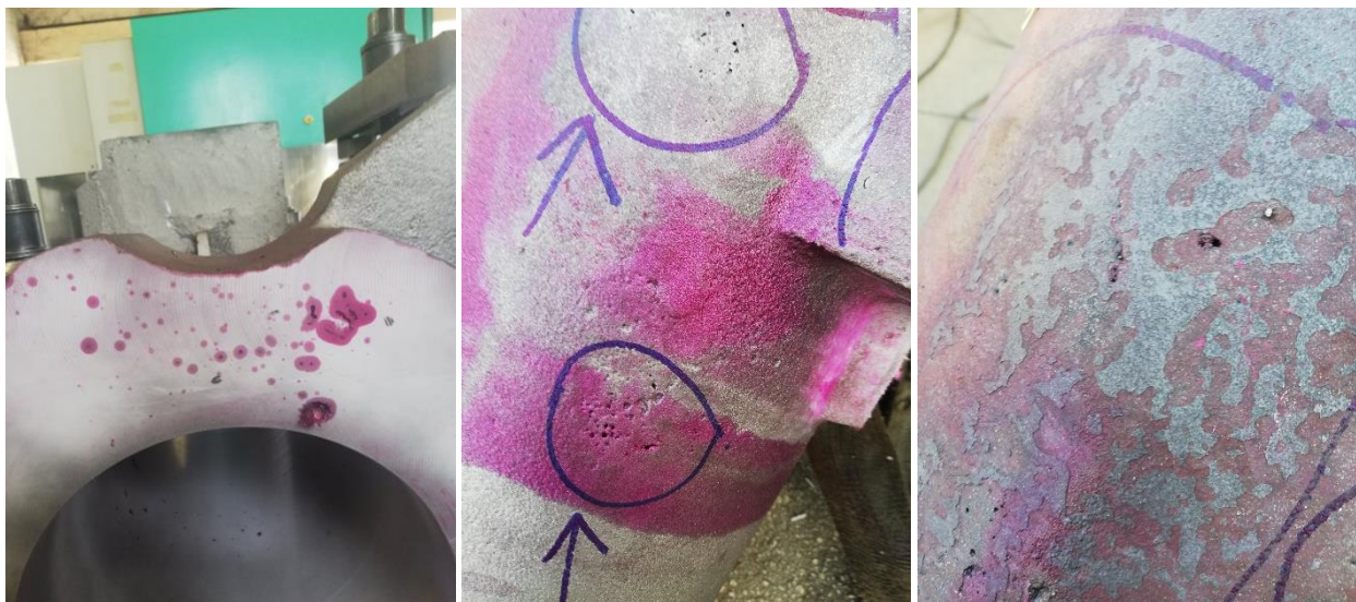
Слика 5.3 Грешке ливења на одговорном делу (тзв "црволика" порозност)
