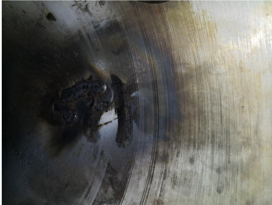
Слика 6.13 Изглед попуњеног жлеба заварима/наварима
