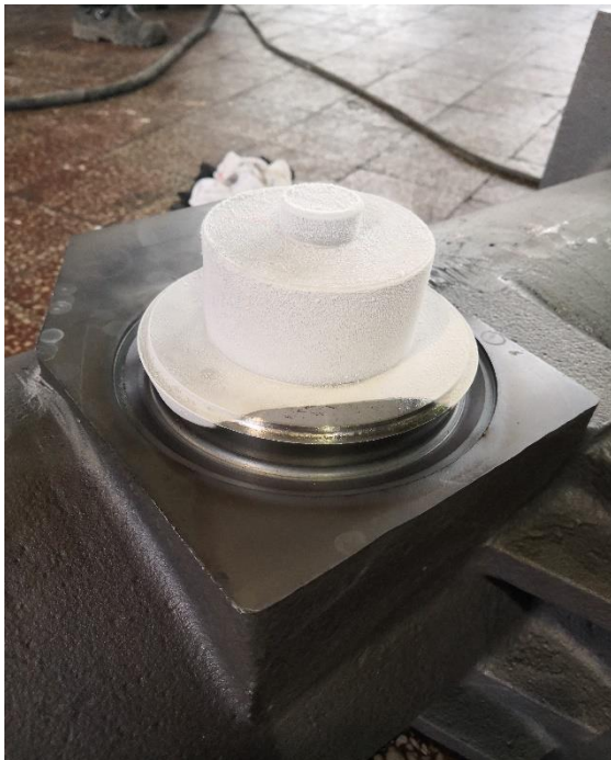
Слика 6.18 Процес изједначавања температура пресованих делова - остваривање чврстог пресованог склопа
