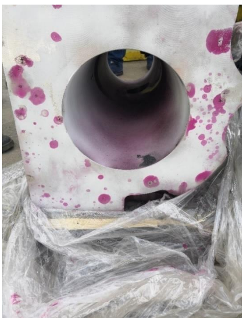
Слика 6.9 Тачкасте грешке (тзв. црволика порозност)
