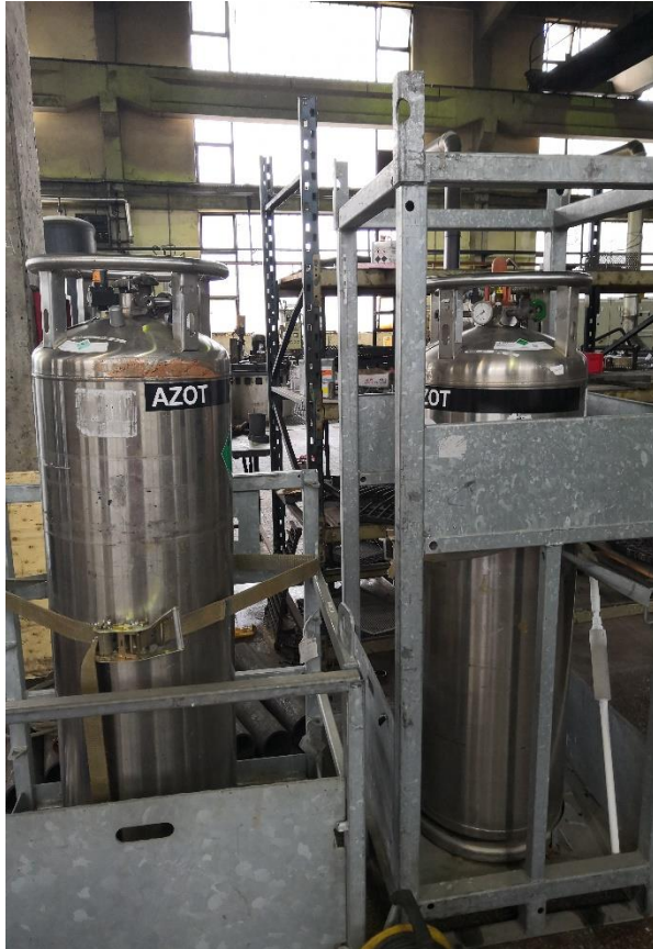
Слика 6.15 Опрема за хлађење течним азотом
