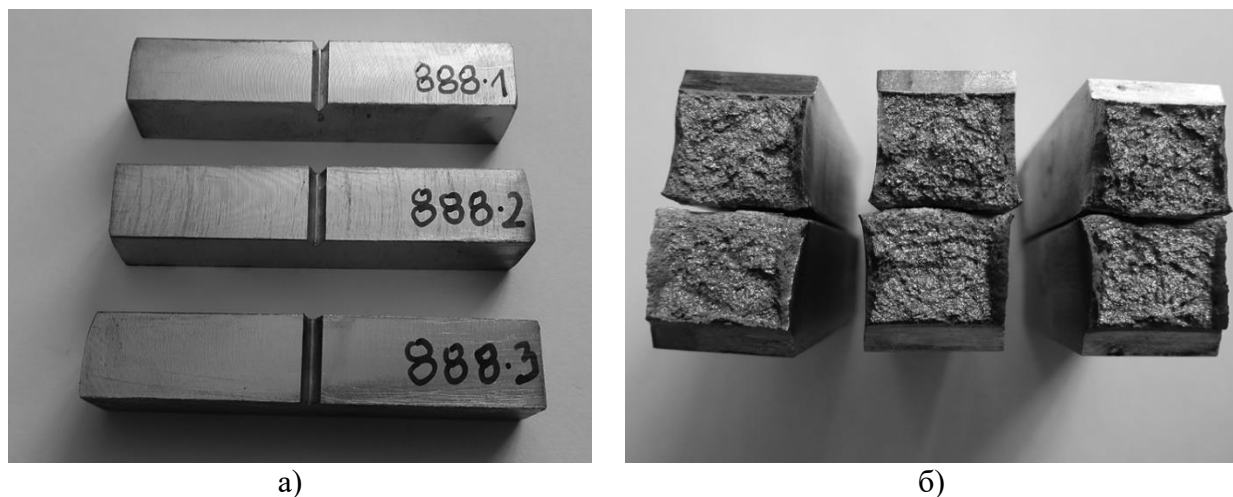
Слика 6.2 Узорци за испитивање ударне жилавости: а) пре лома и б) изглед места прелома
