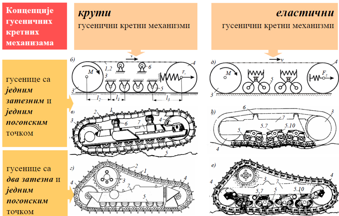
Слика 2.3 Концепти гусеничних кретних механизма
