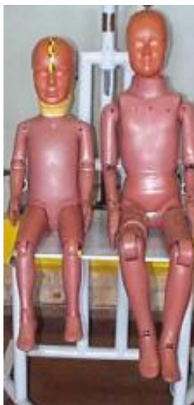
Слика 35 – Лутке деце са сензорима које карактеришу испитиване параметре [22]
