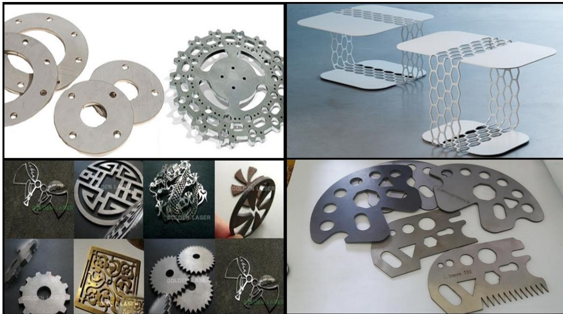
Слика 10. Примери резања ласером металних материјала
